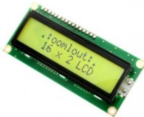
Gambar 2.8 Contoh Bentuk LCD (*Liquid Cristal Display*)
