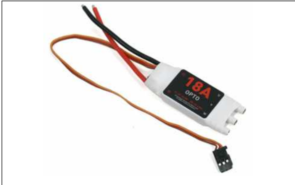
Gambar 2.12 Contoh Bentuk Fisik ESC.
