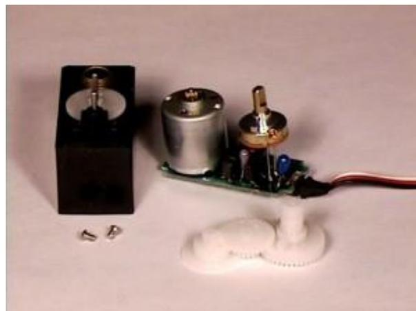
**Gambar 2.10.** Konstruksi Motor Servo
