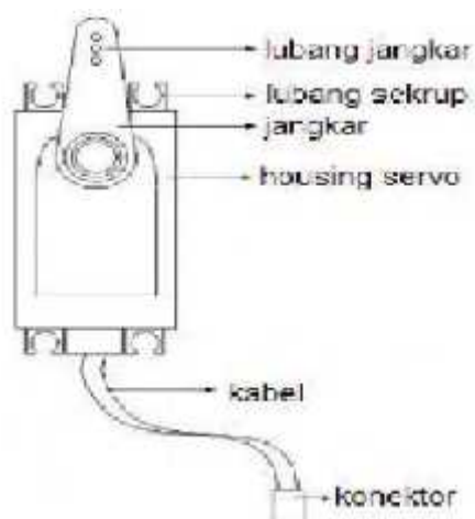
Gambar 2.7 Komponen Luar Motor Servo
