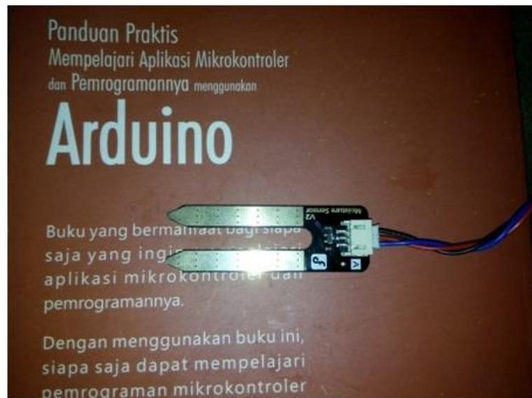
**Gambar 2.2 Sensor kelembapan tanah**
