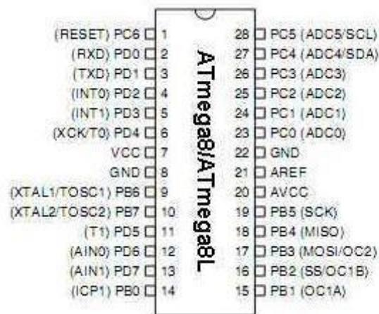
**Gambar 2.9 Konfigurasi Pin Atmega 8/8L**
