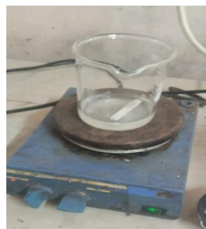
aktivasi zeolit alam dengan NaOH
