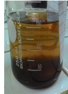
Sampel ditambah NaOH dan didiamkan 30 menit
