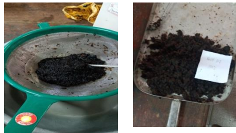
Penyaringan dan pengeringan serat batang pisang
