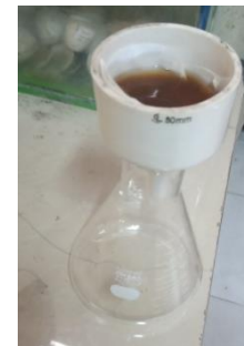
Sampel ditambah NaOH dan didiamkan 30 menit
