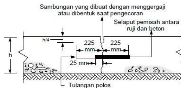
Gambar 2.35 Sambungan Susut Melintang dengan Ruji
