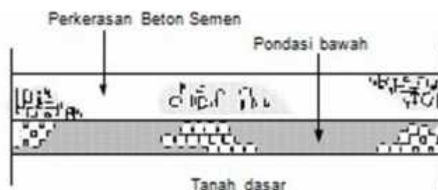
Gambar 2.23 Tipikal Struktur Perkerasan Beton Semen
