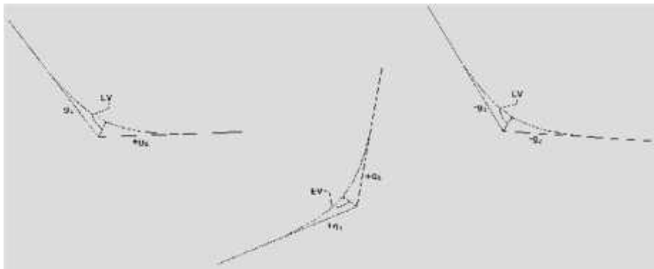
Gambar 2.20 Lengkung Vertikal Cekung
