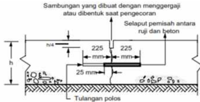
Gambar 2.1 Sambungan Susut Melintang dengan Ruji
