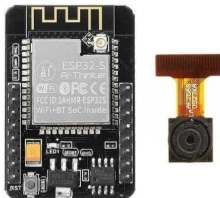
**Gambar 2. 4** ESP-32 CAM
