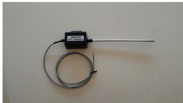
**Gambar 2. 4** Sensor pH Tanah
