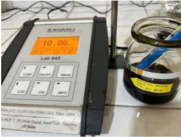
Analisa pH menggunakan pH meter
