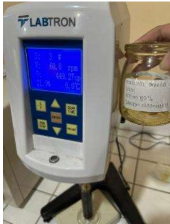
Analisa Viskositas menggunakan alat viskometer Brookfield
