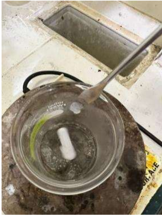
memasukkan texapon ke dalam hydrosol bercampur champhora sembari di hotplate
