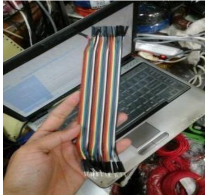
Gambar 2. 2 Kabel Jumper (Sumber: Dokumen pribadi)
