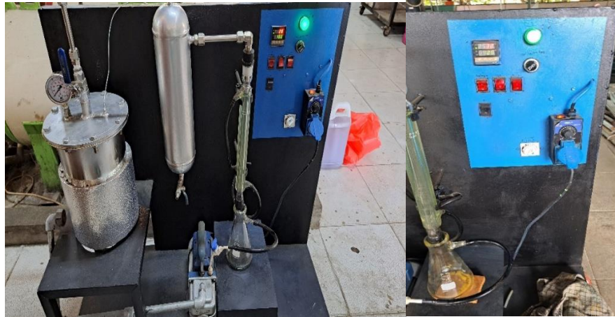
Menyalakan heater dan mengatur suhu pada tombol set dan menunggu hasil produk biofuel keluar
