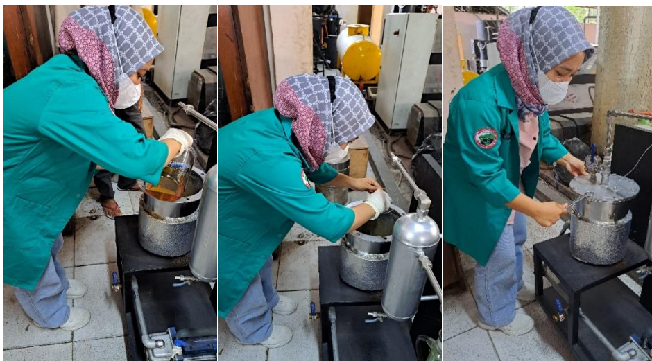
Memasukkan bahan baku dan katalis kedalam reaktor kemudian menutup reaktor dan mengencangkan baut pada reaktor
