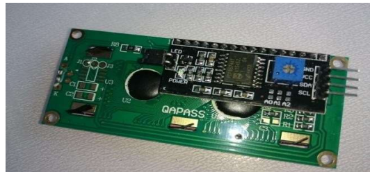
Gambar 2.11 Liquid Crystal Display (LCD) Yang Dipasang Dengan Inter Integrated Circuit (I 2 C)
