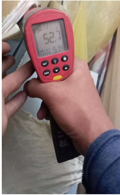
Pengujian Pembacaan Temperatur Dengan Alat Ukur
