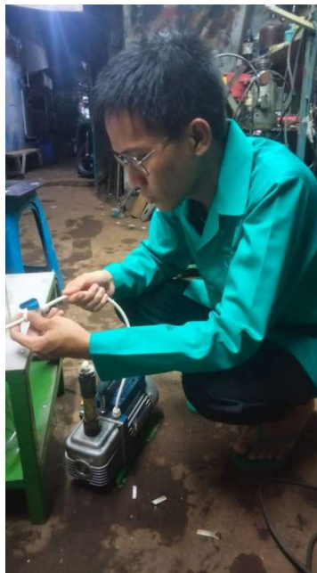
Pengujian Pembacaan Tekanan Dengan Alat Ukur
