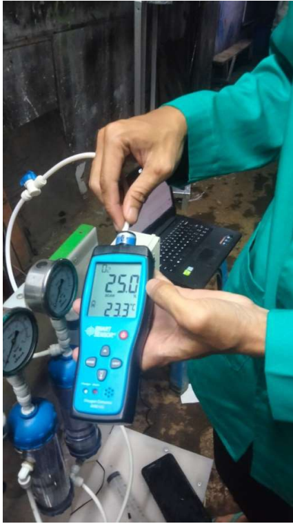
Pengujian Pembacaan Oksigen Dengan Alat Ukur
