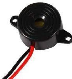
**Gambar 2.9** Bentuk fisik *Buzzer*.
