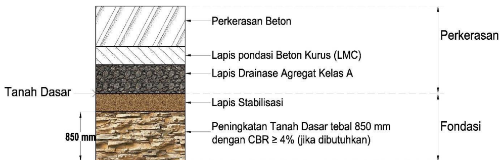
Gambar 2.23 Tipikal struktur perkerasan beton semen
