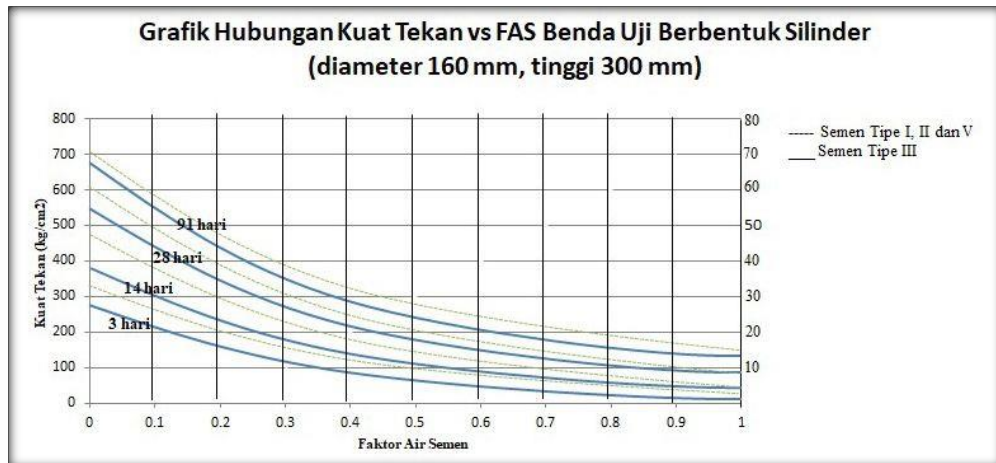
Gambar 2.2 Grafik hubungan antara kuat desak dan faktor air semen untuk benda uji silinder (Sumber : SNI 03-2834-2000)
