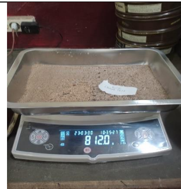
Berat AH Pasir + Cawan (Setelah Oven)
