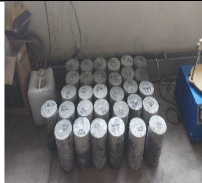
Benda Uji Setelah Perawatan
