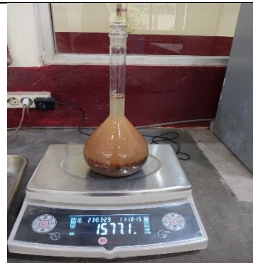
Berat Piknometer + agregat + air
