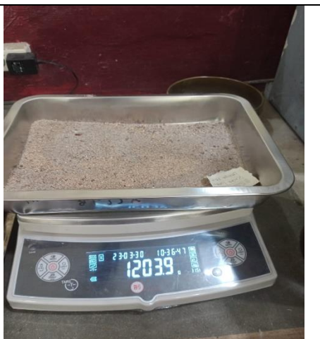
Berat AH Pasir + Cawan Setelah Oven (Konstan 2)
