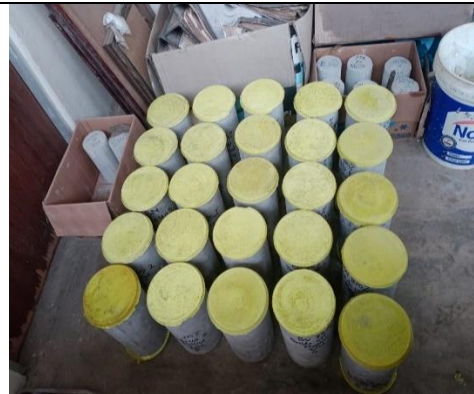
Benda Uji Setelah Capping
