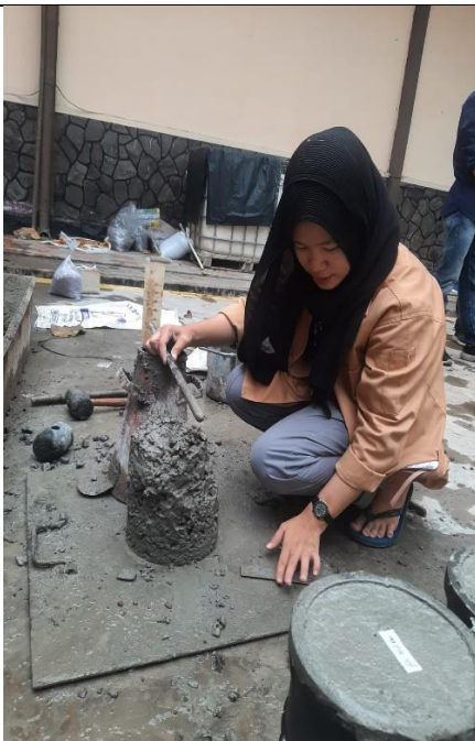
Slump Beton Normal setelah kerucut diangkat
