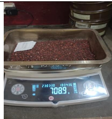
Berat AH Pasir + Cawan (Setelah Oven)
