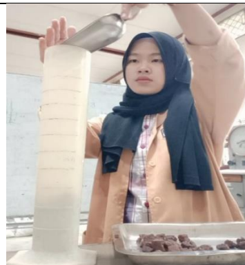
Pengujian Bj SSD Agregat Kasar
