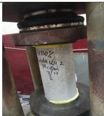
Pengujian Kuat Tekan Beton Variasi 100%
