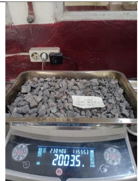
Berat AK Split + Cawan Setelah Oven (Konstan 2)
