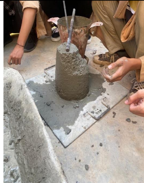
Slump Beton Normal setelah kerucut diangkat
