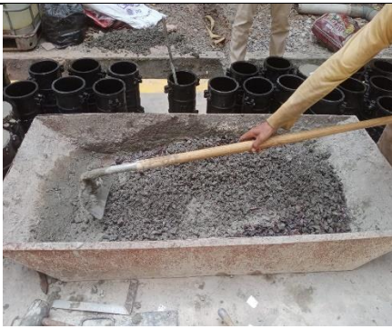
Pembuatan Benda Uji
