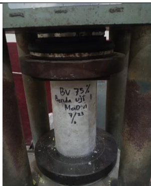
Pengujian Kuat Tekan Beton Variasi 75%
