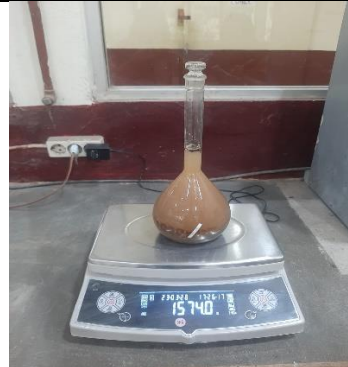
Berat Piknometer + agregat + air
