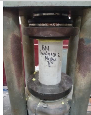
Pengujian Kuat Tekan Beton Normal
