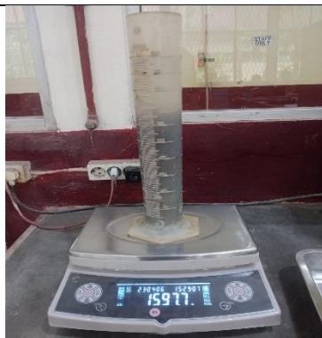
Berat Piknometer + agregat + air
