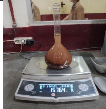
Berat Piknometer + agregat + air
