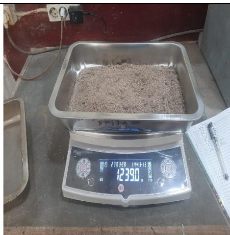
Berat AH Pasir + Cawan Setelah Oven (Konstan 1)
