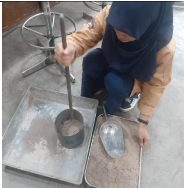
Pengujian Bobot Isi Agregat Halus
