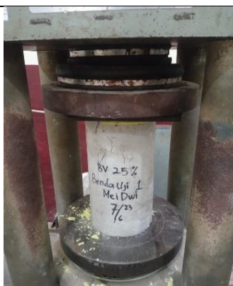
Pengujian Kuat Tekan Beton Variasi 25%
