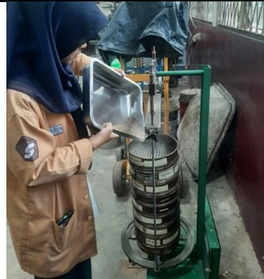
Pengujian Analisa Saringan
