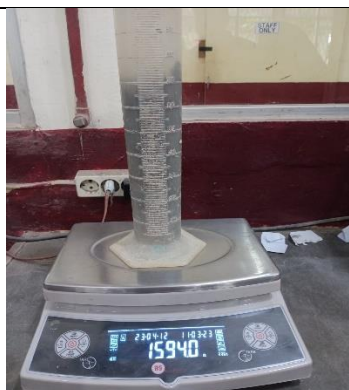
Berat Piknometer + agregat + air
