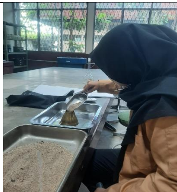
Pengujian Bj SSD Agregat Halus
