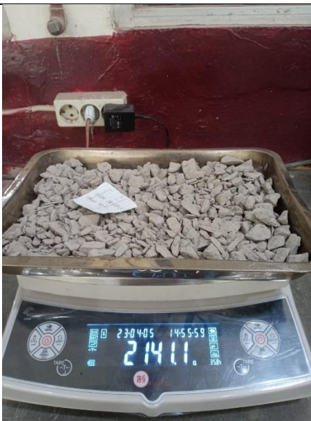
Berat AK Split + Cawan Setelah Oven (Konstan 1)
