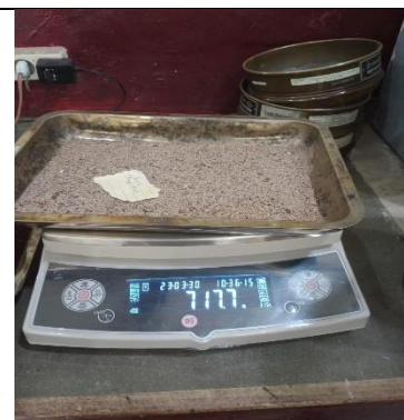
Berat AH Pasir + Cawan (Setelah Oven)
