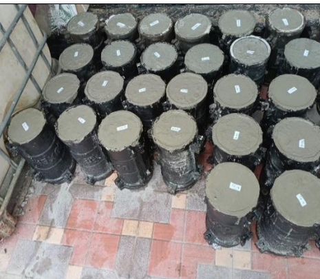
Pengecoran Seluruh Benda Uji
