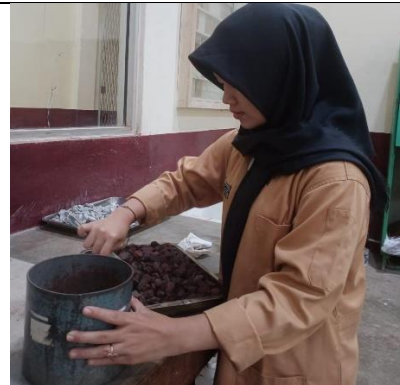
Pengujian Bobot Isi Agregat Kasar
