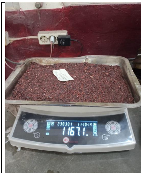
Berat AH BBK + Cawan Setelah Oven (Konstan 2)
