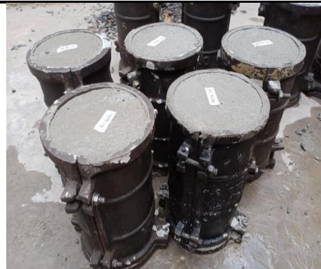
Pengecoran Beton Variasi 25%
