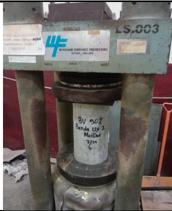
Pengujian Kuat Tekan Beton Variasi 50 %
