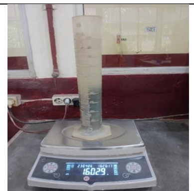
Berat Piknometer + agregat + air
