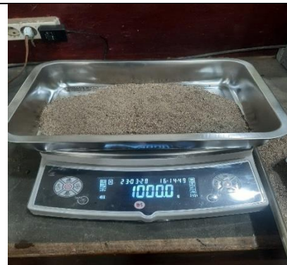
Berat Agregat Halus Pasir tanpa Cawan
