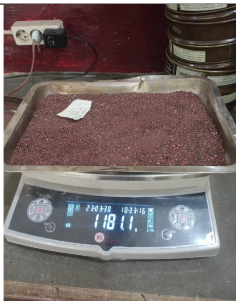
Berat AH BBK + Cawan Setelah Oven (Konstan 1)
