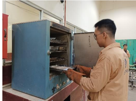
Memasukkan benda uji kedalam oven untuk dikeringkan
