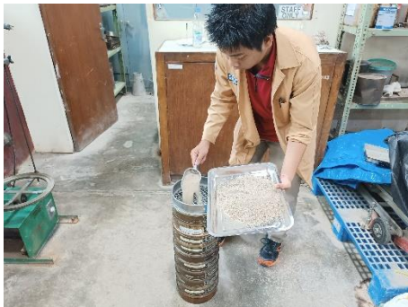
Benda uji dimasukkan ke dalam ayakan secara berurutan
