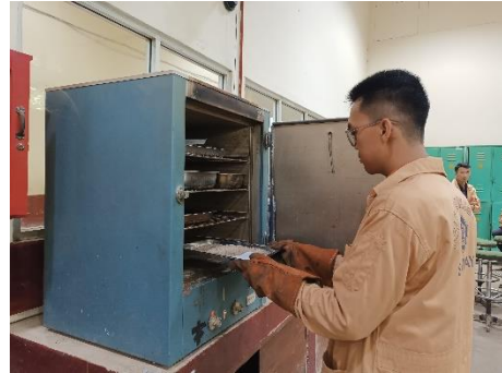
Memasukkan benda uji kedalam oven untuk dikeringkan
