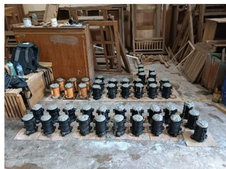
Tunggu mortar busa hingga mengeras (umur 24 jam) sehingga bisa untuk dibuka
