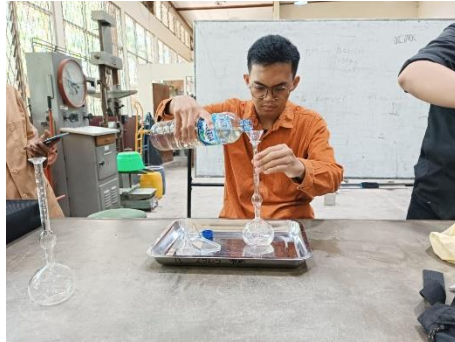
Memasukkan kerosin ke dalam botol le chatelier
