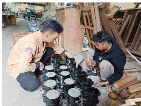
Masukkan campuran mortar busa ke dalam cetakan benda uji silinder
