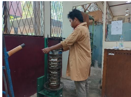
Melakukan penguncian diatas alat penggetar
