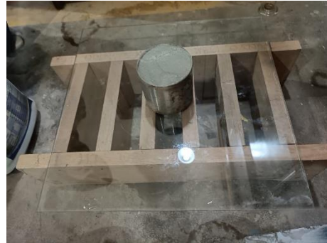
Tuangkan campuran mortar busa ke dalam ring flow
