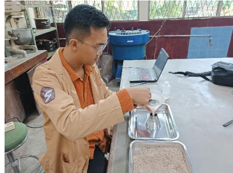
Pasir dimasukkan kedalam kerucut terpancung secara bertahap
