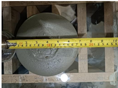
Ukur nilai flow campuran mortar busa menggunakan meteran
