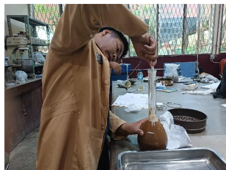
Pembersihan gelembung udara di dalam air
