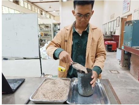
Memasukkan benda uji kedalam penakar
