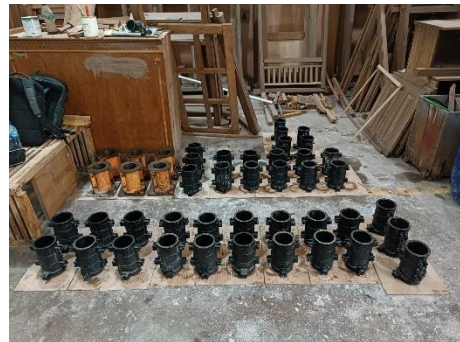
Persiapkan cetakan benda uji silinder yang sudah diolesi menggunakan oli
