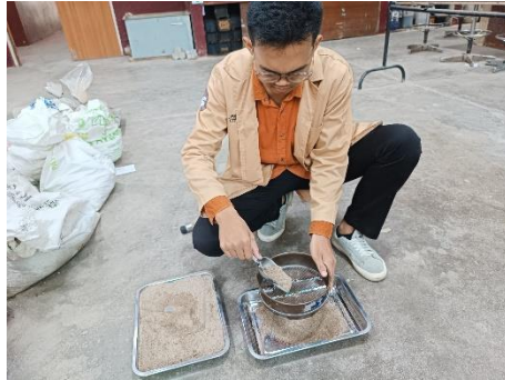
Agregat halus disaring menggunakan saringan no. 4
