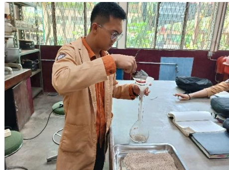
Memasukkan pasir ke dalam botol piknometer
