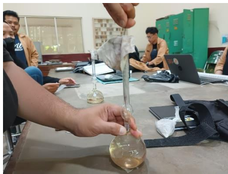
Membersihkan semen yang menempel pada dinding dalam botol
