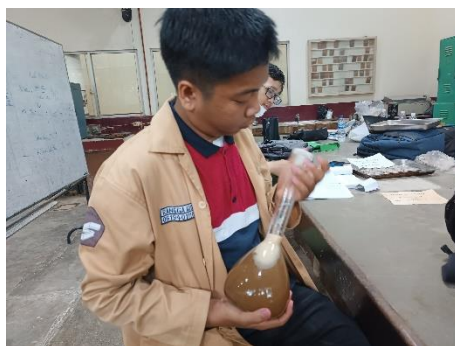
Dilakukan penguncangan untuk menghilangkan gelembung udara di dalam air
