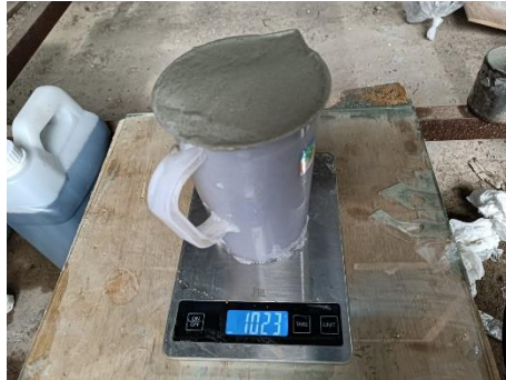
Timbang densitas basah campuran mortar busa
