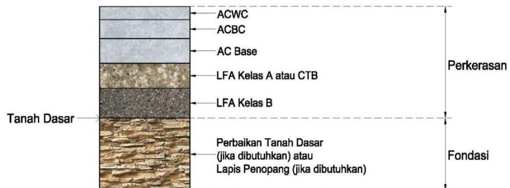
Gambar 2.38 Perkerasan Lentur pada Permukaan Tanah Asli
