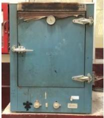
Oven         | Digunakan untuk mengeringkan material                    | Semua jenis pengujian yang dilakukan dalam penelitian |
