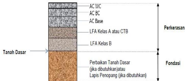
Gambar 2.25 Perkerasan Lentur Pada Permukaan Tanah Asli
