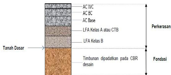
Gambar 2.26 Perkerasan Lentur pada timbunan
