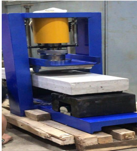
Gambar 2.14 Dinding Panel beton dengan dua titik pembebanan
