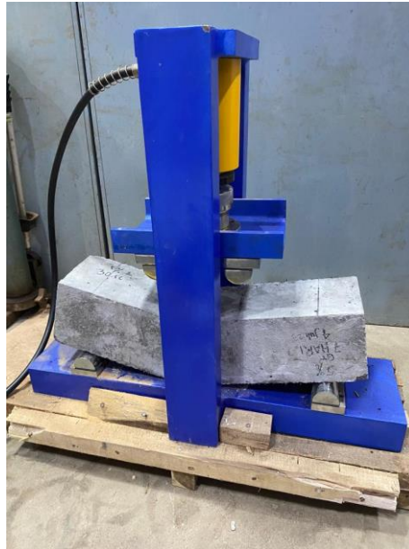
Gambar 2.8 Balok uji dengan dua titik pembebanan
