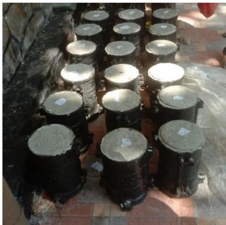
Gambar 3.7 Pencetakan Benda Uji
