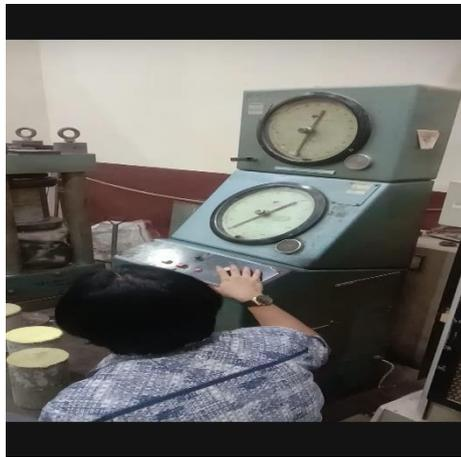
Gambar 3.9 Alat Pengujian Kuat Tekan
