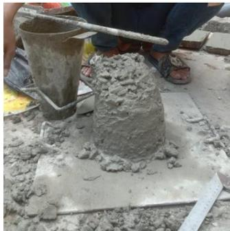
Gambar 3.6 Pengujian *Slump*
