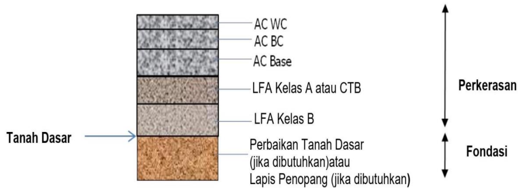
Gambar 2.34 Perkerasan Lentur pada galian
