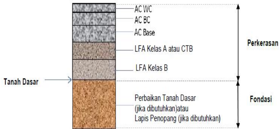
Gambar 2.32 Perkerasan Lentur Pada Permukaan Tanah Asli
