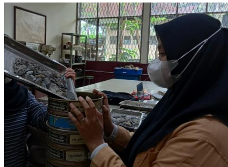
Gambar 2.3 Pemasukan Benda Uji kedalam Saringan
