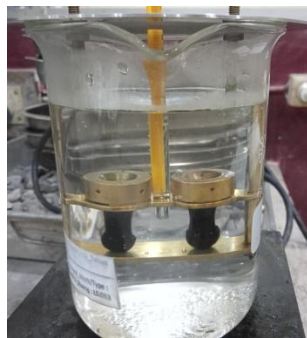
Gambar 12.4 Pengujian Titik Lembek
