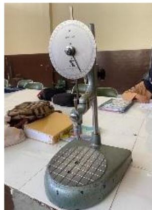
Gambar 13.2 Pemasangan Pemberat dan Jarum Penetrasi Penetrometer
