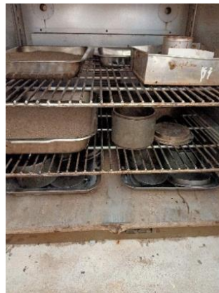
Gambar 7.2 Pengovenan Agregat Halus hingga berat konstan
