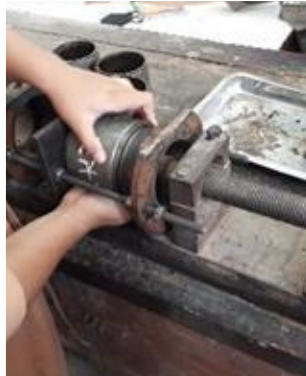
Gambar 17.12 Pengeluaran Benda Uji Dari Cetakan
