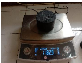
Gambar 18.5 Penimbangan berat kering permukaan
