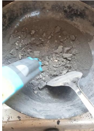
Gambar 17.3 Pemasakkan Benda Uji Hingga Suhu 150°C
