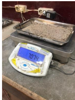
Gambar 5.2 Penimbangan Benda Uji Agregat Halus Keadaan Kering Permukaan Jenuh/SSD
