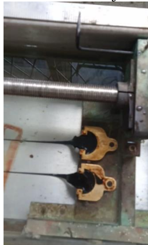
Gambar 14.5 Pengujian Daktilitas Aspal
