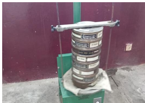
Gambar 2.4 Pengayakan Benda Uji Selama 15 Detik
