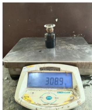
Gambar 11.5 Penimbangan Bejana Gelas + Aspal + Air
