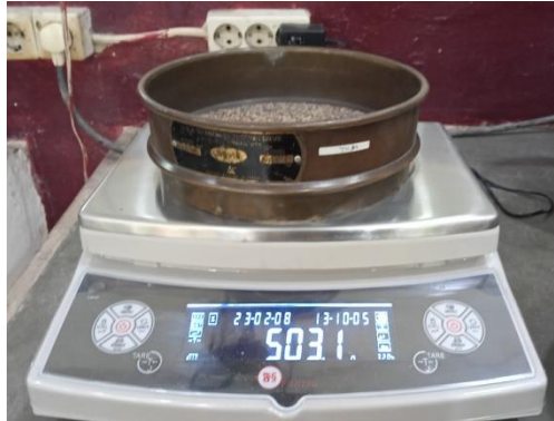
Gambar 2.5 Penimbangan Berat Agregat Tertahan Dalam Saringan
