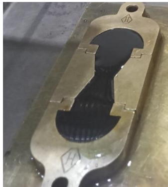
Gambar 14.3 Penuangan Aspal ke Cetakan Daktilitas
