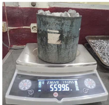
Gambar 8.3 Penimbangan Agregat kasar
