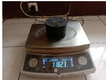
Gambar 18.3 Penimbangan Berat Kering di Udara
