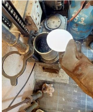
Gambar 17.9 Penyusunan Kertas Saring
