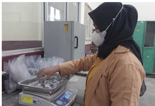
Gambar 4.1 Penimbangan Berat Benda Uji
