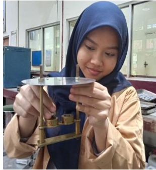
Gambar 12.3 Pemasangan cincin kuningan, alat pengarah bola, bola-bola baja dan termometer diatas dudukan benda uji
