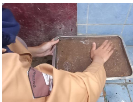
Gambar 7.3 Pencucian Agregat Halus
