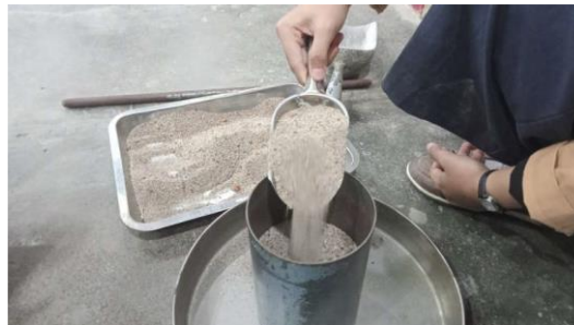
Gambar 9.2 Penuangan Agregat Halus ke Dalam Bejana Silinder
