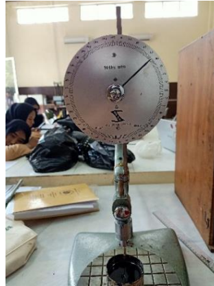
Gambar 13.4 Pembacaan Angka Penetrasi
