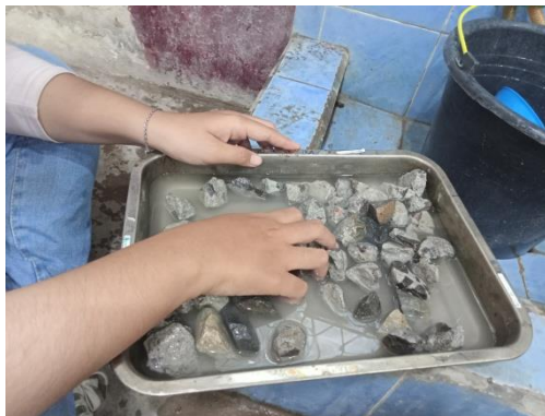
Gambar 6.3 Pencucian Agregat Kasar Yang Sudah Konstan
