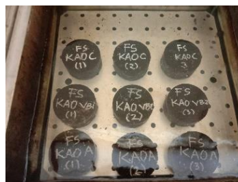
Gambar 18.6 Perendaman benda uji di dalam Waterbath selama 30 menit
