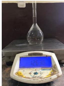
Gambar 5.3 Penimbangan Pycnometer kosong dan penimbangan pycnometer + Air
