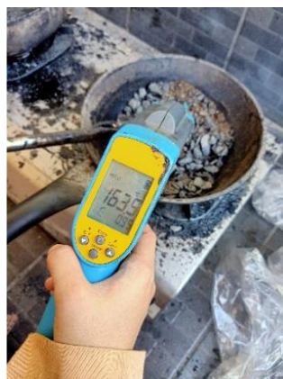
Gambar 17.5 Pemasakkan Benda Uji hingga Suhu 165°C
