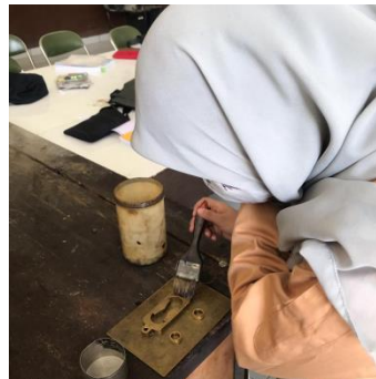
Gambar 14.2 Penyiapan Cetakan Daktilitas
