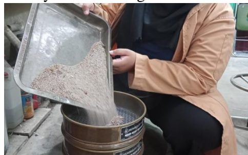
Gambar 3.3 Pemasukan Benda Uji kedalam Saringan
