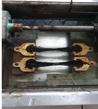
Gambar 14.4 Perletakkan Benda Uji ke Alat Uji Daktilitas
