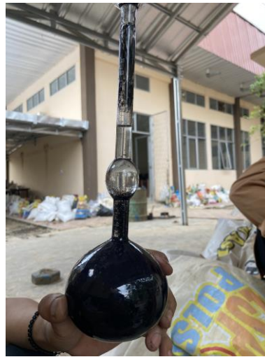
Gambar 16.12 Pemasukkan fly ash Sebanyak 64 gram
