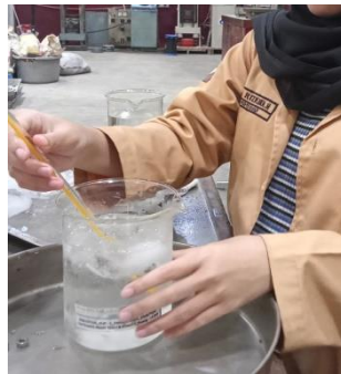
Gambar 12.3 Pengaturan Temperatur Air Hingga Mencapai Suhu 5°C
