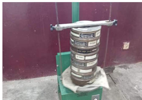
Gambar 2.4 Pengayakan Benda Uji Selama 15 Detik
