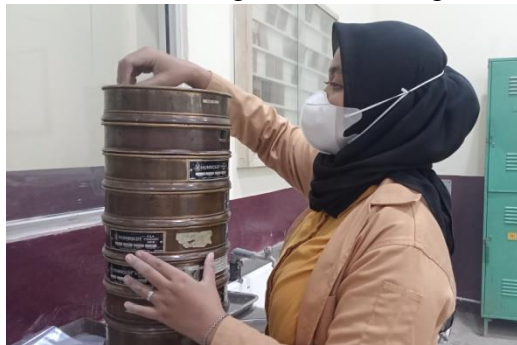
Gambar 3.2 Penyusunan Saringan Sesuai Nomor Saringan
