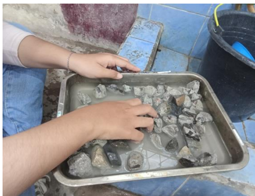
Gambar 6.3 Pencucian Agregat Kasar Yang Sudah Konstan
