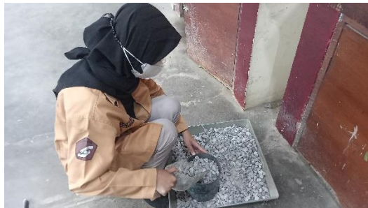
Gambar 8.2 Penuangan Agregat Kasar ke Dalam Bejana Silinder
