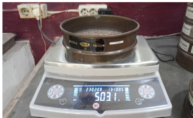
Gambar 3.5 Penimbangan Berat Agregat Tertahan Dalam Saringan
