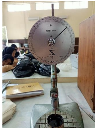
Gambar 13.4 Pembacaan Angka Penetrasi
