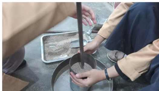
Gambar 9.4 Penumbukan Agregat Halus Sebanyak 25 kali tumbukan pada Setiap Lapisan
