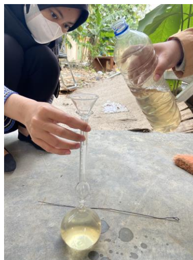
Gambar 16.1 Pemasukkan Minyak Tanah ke Dalam Botol Le Chatelier
