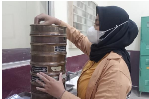
Gambar 2.2 Penyusunan Saringan Sesuai Nomor Saringan
