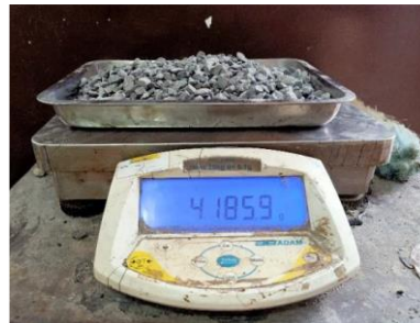
Gambar 10.10 Penimbangan Berat Agregat Tertahan disaringan 2,36 mm
