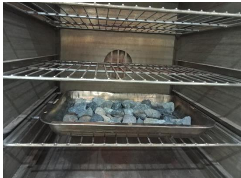
Gambar 6.2 Pengovenan Agregat Kasar Hingga Berat Konstan
