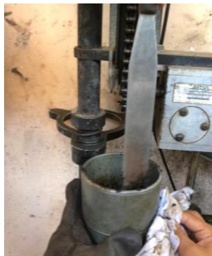
Gambar 17.8 Penusukkan Bagian Pinggir 15x dan Tengah 10x
