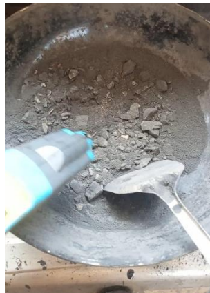
Gambar 17.3 Pemasakkan Benda Uji Hingga Suhu 150°C
