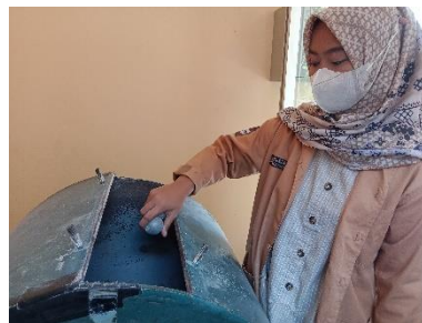
Gambar 10.4 Pemasukkan Bola Baja Ke Dalam Mesin Los Angeles
