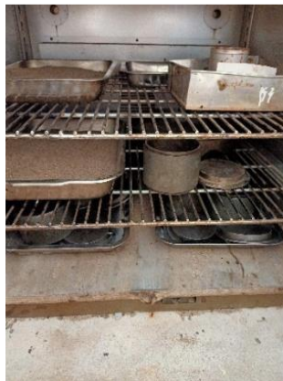
Gambar 7.2 Pengovenan Agregat Halus hingga berat konstan
