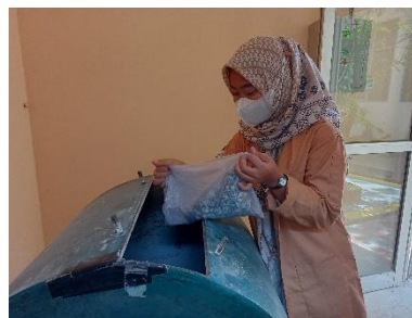
Gambar 10.3 Pemasukkan Benda Uji Ke Dalam Mesin Los Angeles
