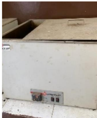
Gambar 18.1 Penyiapan Waterbath Hingga Suhu 60°C
