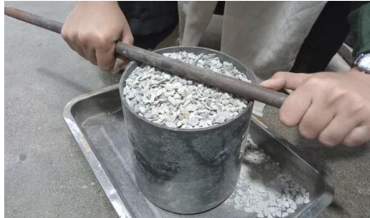
Gambar 8.5 Perataan Agregat Kasar
