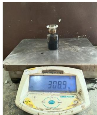
Gambar 11.5 Penimbangan Bejana Gelas + Aspal + Air
