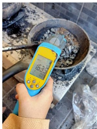
Gambar 17.5 Pemasakkan Benda Uji hingga Suhu 165°C
