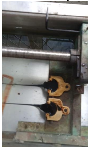
Gambar 14.5 Pengujian Daktilitas Aspal
