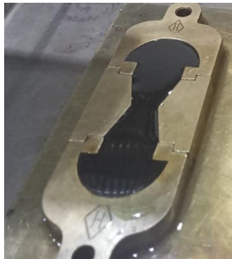
Gambar 14.3 Penuangan Aspal ke Cetakan Daktilitas
