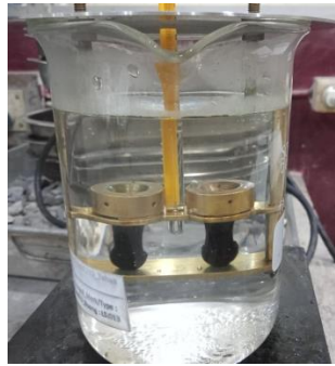
Gambar 12.4 Pengujian Titik Lembek
