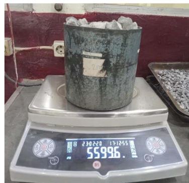
Gambar 8.3 Penimbangan Agregat kasar
