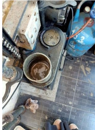
Gambar 17.6 Penyusunan mould dialat penumbuk Marshall
