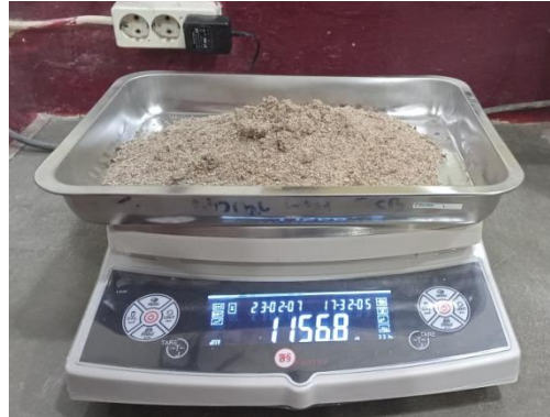
Gambar 7.1 Penimbangan Agregat Halus
