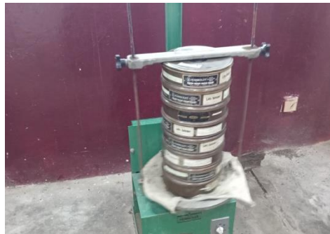
Gambar 3.4 Pengayakan Benda Uji Selama 15 Detik
