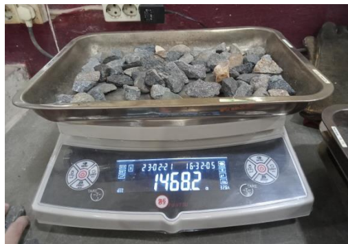
Gambar 4.6 Penimbangan Benda Uji
