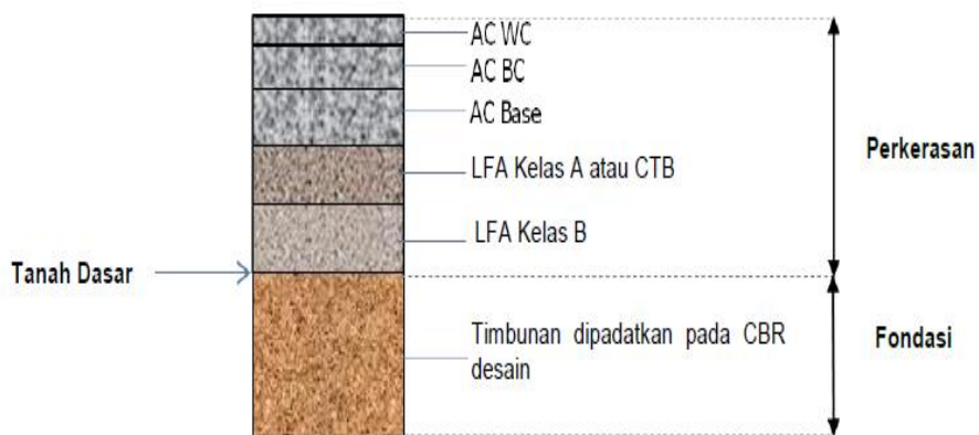
Gambar 2.26 Perkerasan Lentur pada Timbunan
