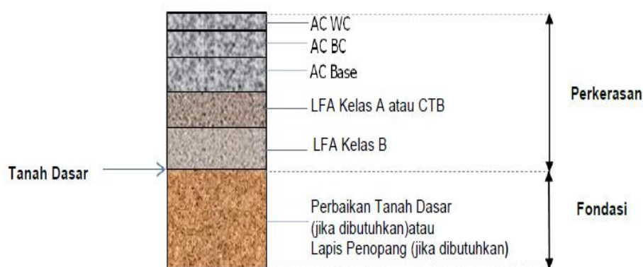
Gambar 2.25 Perkerasan Lentur pada Permukaan Tanah Asli
