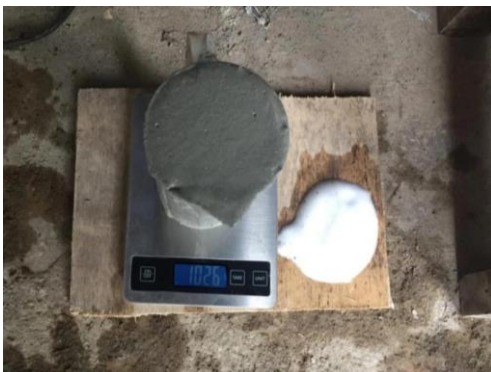
Penimbangan mortar busa
