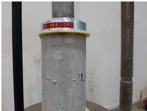
Retak pada mortar busa yang sudah diuji
