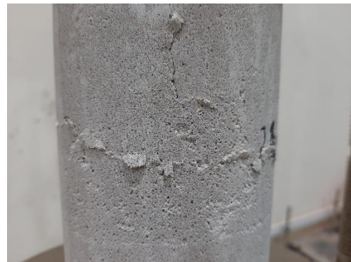
Retak pada mortar busa yang sudah diuji (2)
