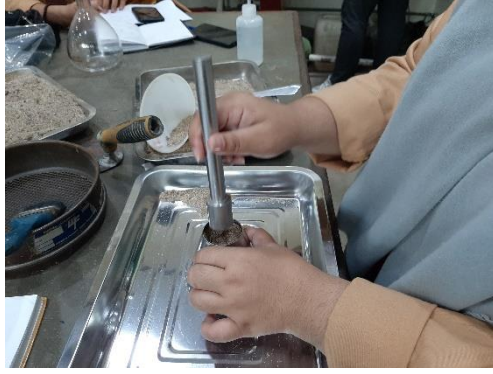
Proses memasukkan dan menumbuk benda uji
