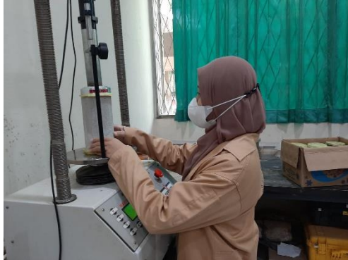
Proses meletakkan benda uji pada alat uji kuat tekan
