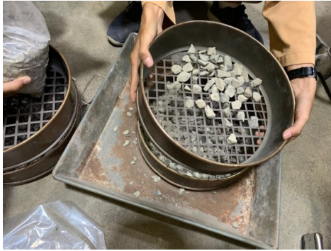
Proses penyaringan agregat kasar
