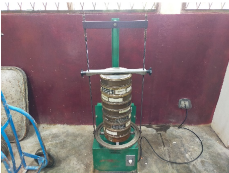
Proses penyaringan dengan mesin
