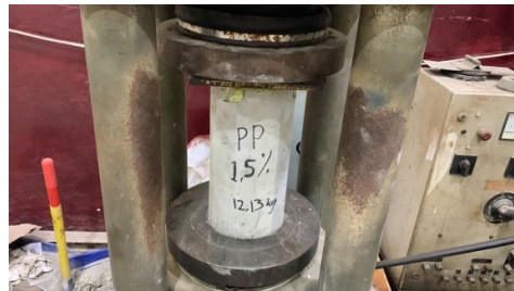
Hasil keretakan beton berserat 2 umur 14 hari
