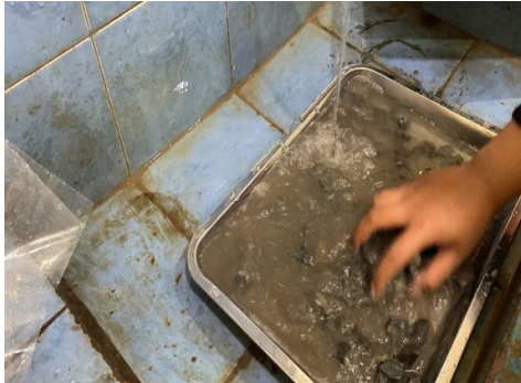
Proses membersihkan agregat dari kotoran
