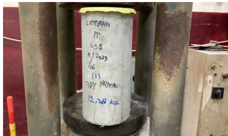
Hasil keretakan beton berserat 1 umur 7 hari
