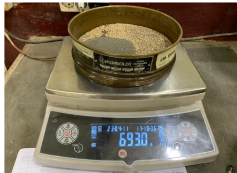
Proses penimbangan benda uji tertahan pada saringan
