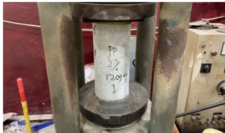
Proses pengujian kuat tekan
