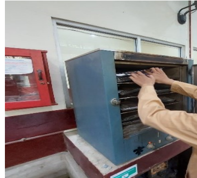
Proses memasukkan agregat ke dalam oven
