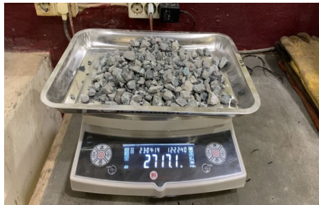
Penimbangan agregat setelah uji kekerasan agregat
