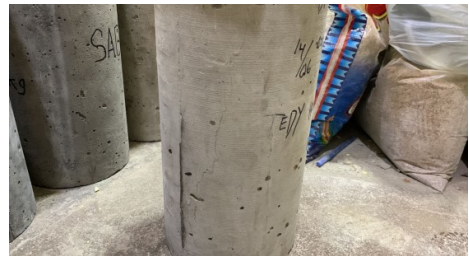
Hasil keretakan beton normal 1 umur 7 hari
