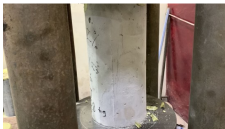
Hasil keretakan beton berserat 3 umur 28 hari
