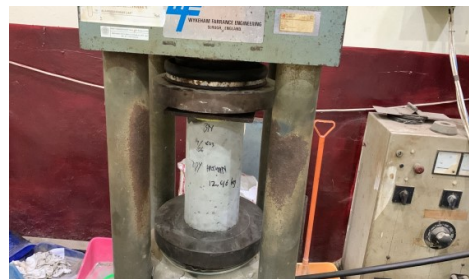
Proses pengujian kuat tekan
