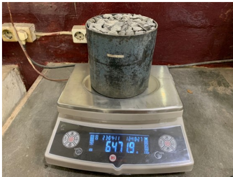
Penimbangan bobot isi agregat kasar
