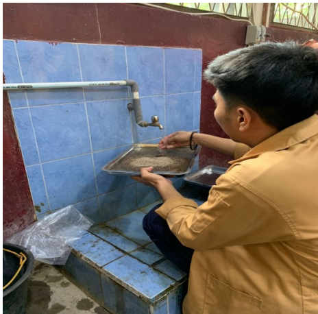
Proses pembersihan agregat dari kotoran
