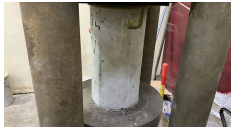
Hasil keretakan beton normal 2 umur 14 hari
