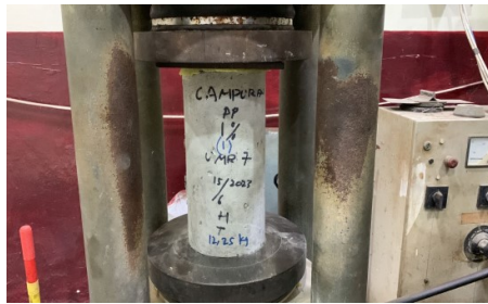
Proses pengujian kuat tekan
