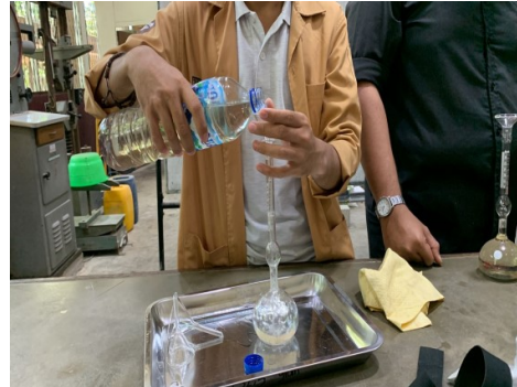
Proses penuangan minyak tanah kedalam Le Chatelier
