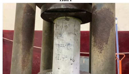
Hasil keretakan beton normal 3 umur 28 hari
