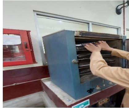
Proses memasukkan agregat ke dalam oven
