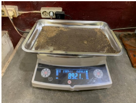
Proses penimbangan benda yang telah dikeluarkan dari piknometer
