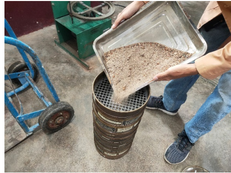
Proses memasukkan benda uji kedalam saringan
