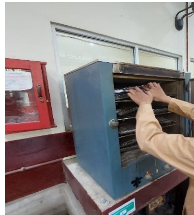
Proses memasukkan agregat ke dalam oven
