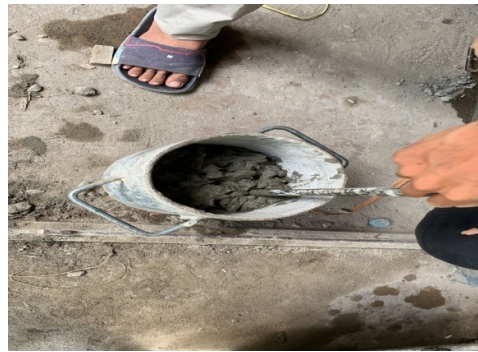
Proses pengujian bobot isi beton
