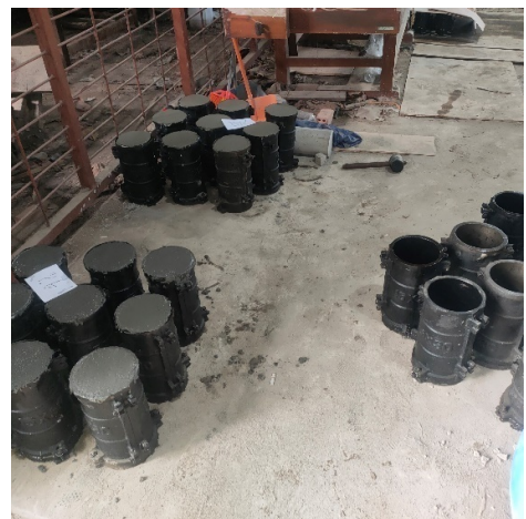
Proses penuangan kedalam cetakan silinder
