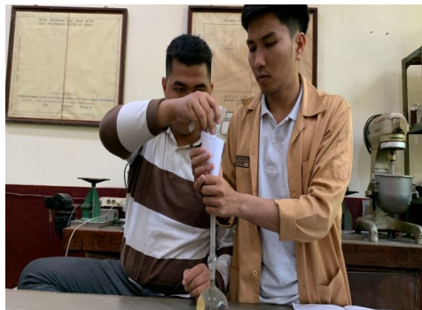
Proses penuangan semen kedalam Le Chatelier
