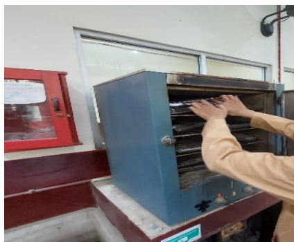
Proses memasukkan agregat yang telah dicuci ke dalam oven
