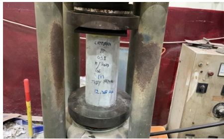
Proses pengujian kuat tekan
