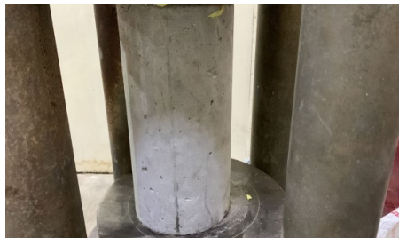
Hasil keretakan beton berserat 1 umur 7 hari
