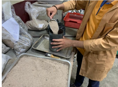
Proses memasukan benda uji kedalam bejana silinder
