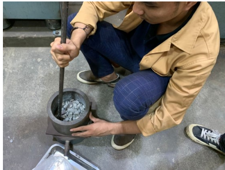
Proses penumbukan agregat kasar
