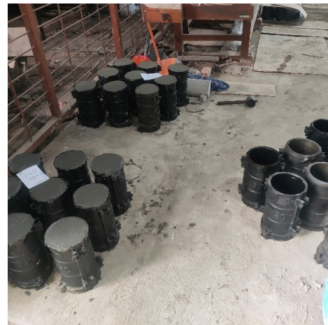
Proses penuangan kedalam cetakan silinder
