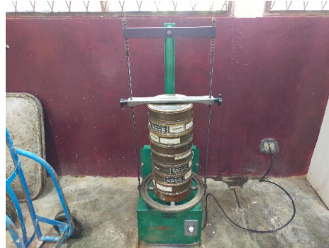
Proses penyaringan dengan mesin penggetar
