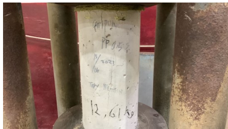
Hasil keretakan beton berserat 3 umur 28 hari
