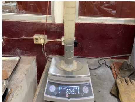
Penimbangan berat piknometer + air + benda uji
