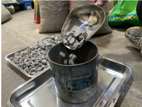
Proses memasukkan benda uji kedalam bejana silinder
