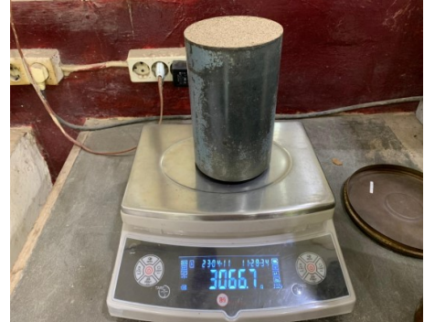
Proses penimbangan benda uji
