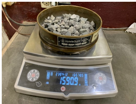
Proses penimbangan benda uji tertahan pada saringan
