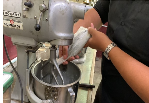
Proses pembuatan benda uji dengan mesin pengaduk
