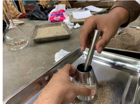
Proses penumbukan untuk mencari keadaan SSD
