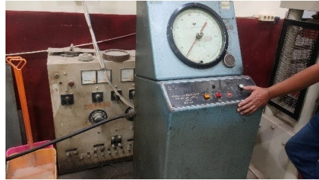
Proses pengoprasian mesin kuat tekan
