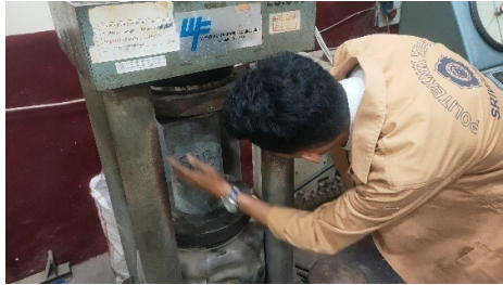
Proses memasukkan benda uji beton pada mesin kuat tekan beton
