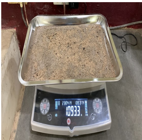
Proses penimbangan hasil benda uji kering oven
