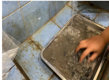
Proses pembersihan agregat dari kotoran
