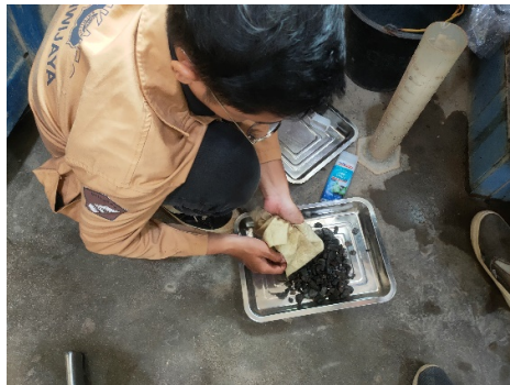
Proses agregat dilap untuk mendapatkan keadaan SSD
