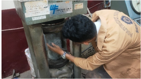
Proses memasukkan benda uji beton pada mesin kuat tekan beton
