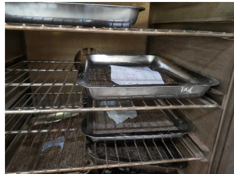
Proses Pengeringan benda uji
