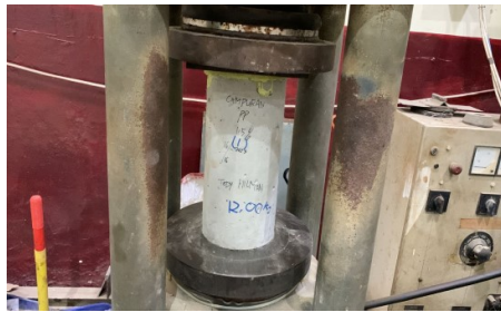
Proses pengujian kuat tekan
