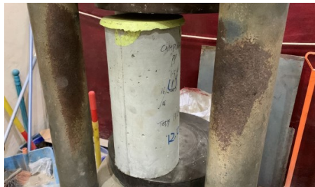
Hasil keretakan beton berserat 1 umur 7 hari
