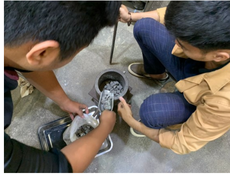
Proses memasukkan agregat pada bejana
