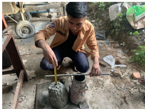
Pembacaan slump test
