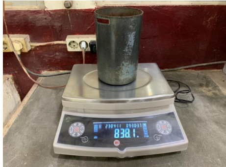
Proses penimbangan benda uji
