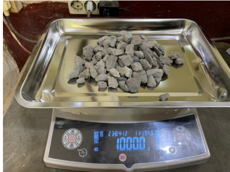
Proses penimbangan benda uji
