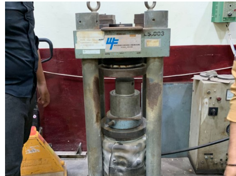
Proses pengujian kekerasan agregat
