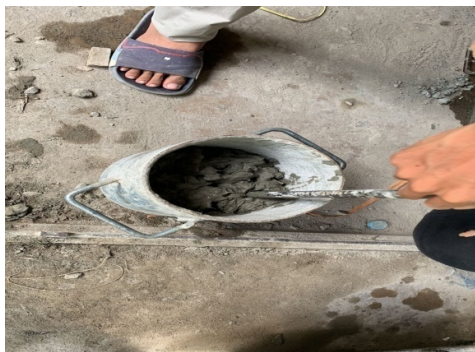
Proses pengujian bobot isi beton
