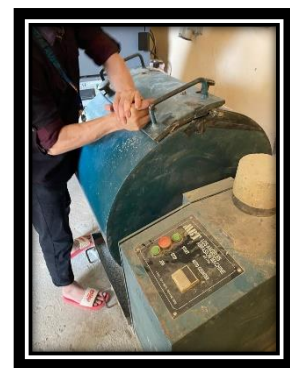
Proses Pengujian Keausan Agregat
