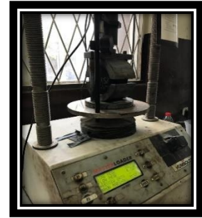
Proses Pengujian Dengan Alat Marshall
