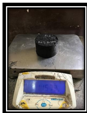
Penimbangan Benda Uji Kondisi Kering
