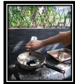
Proses Pencampuran Agregat dan Aspal
