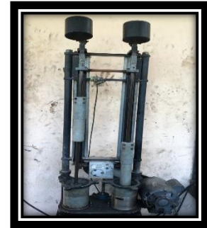
Proses Penumbukan dengan Alat Marshall
