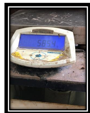
Penimbangan Benda Uji di Dalam Air
