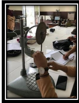
Persiapan Pengujian Penetrasi
