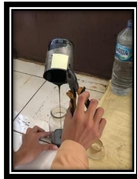
Proses Memasukkan Aspal Ke Piknometer
