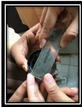
Pengukuran Diameter Benda Uji Penetrasi
