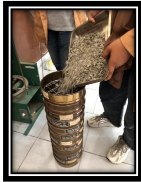
Proses Memasukkan Agregat ke dalam Saringan
