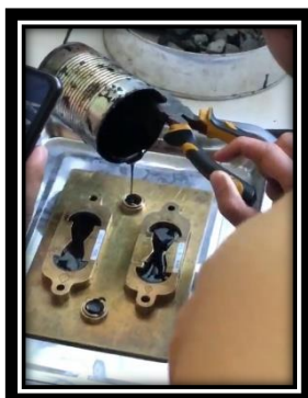
Pencetakan Benda Uji Titik Lembek
