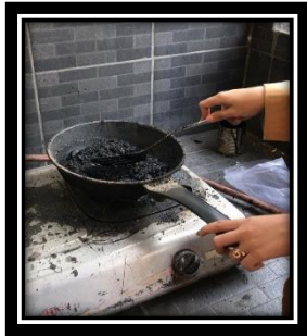
Pengadukan Campuran Agregat dan Aspal
