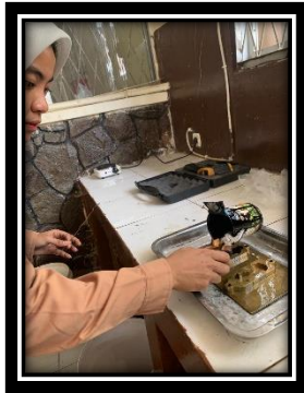
Pencetakan Benda Uji Daktalitas
