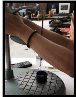
Penurunan Jarum Penetrasi
