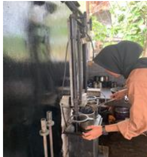
Proses Pencetakan Benda Uji Campuran Aspal
