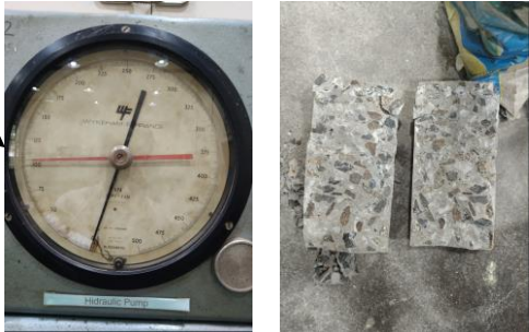
Benda Uji Dan Hasil Yang Didapat Pada Pengujian Kuat Tarik Belah
