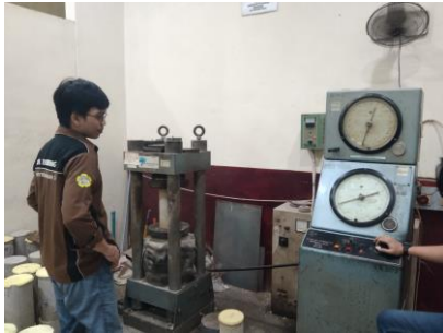
Proses Pengujian kuat tarik belah beton
