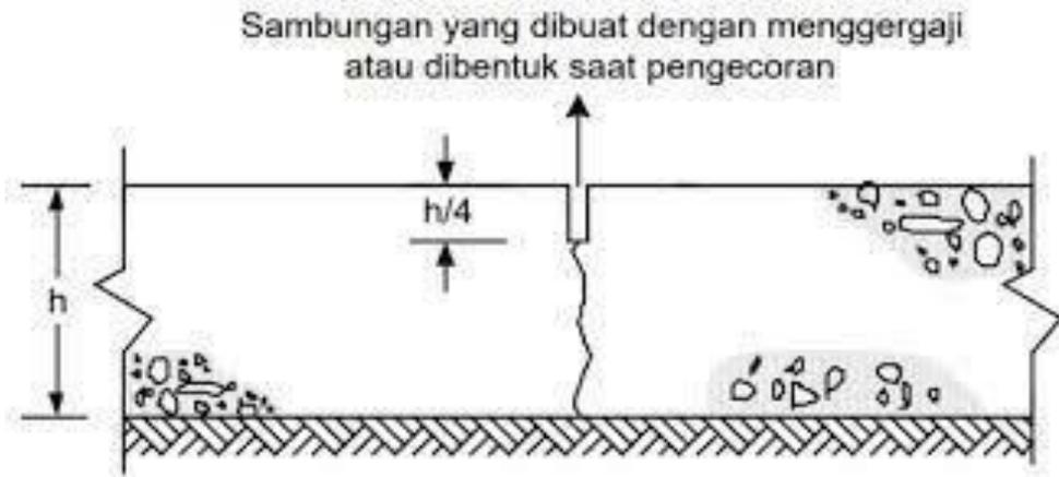
Gambar 2.30 Sambungan Susut Melintang Tanpa Ruji
