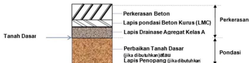
Gambar 2.23 Tipikal Perkerasan Kaku Pada Permukaan Tanah Asli (*at grade*)
