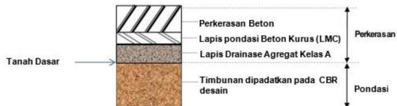
Gambar 2.24 Tipikal Perkerasan Kaku Pada Timbunan
