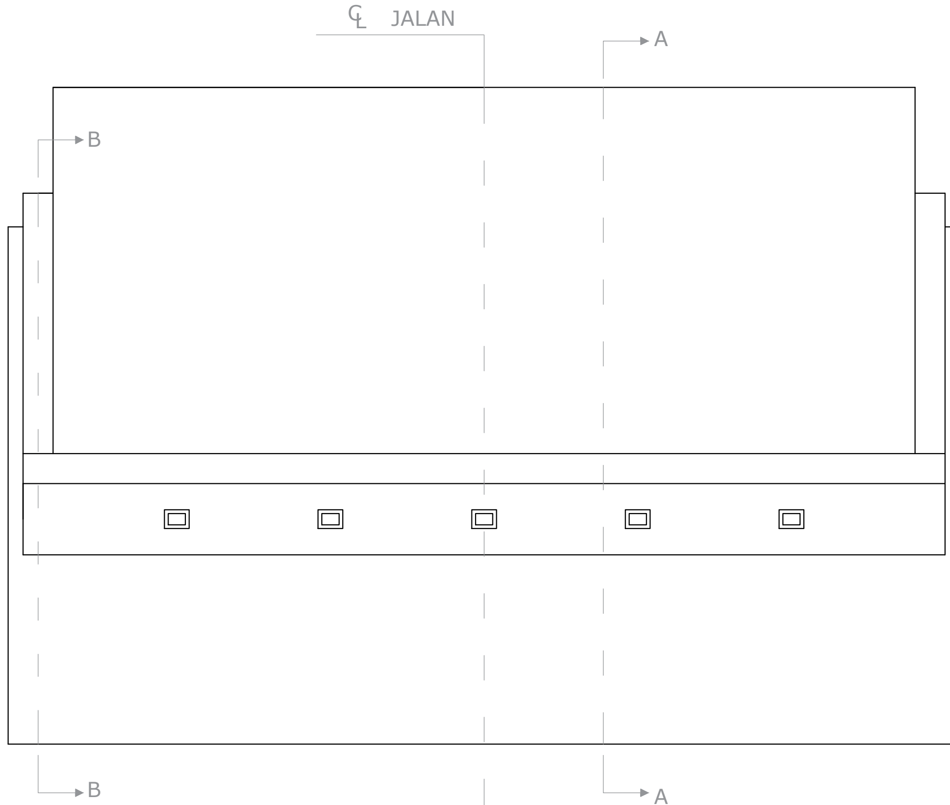
TAMPAK ATAS ABUTMENT Skala 1:50
