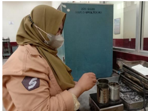
Gambar 14.1 Pemanasan Aspal Sebanyak 50 Gram Menggunakan Hot Plate
