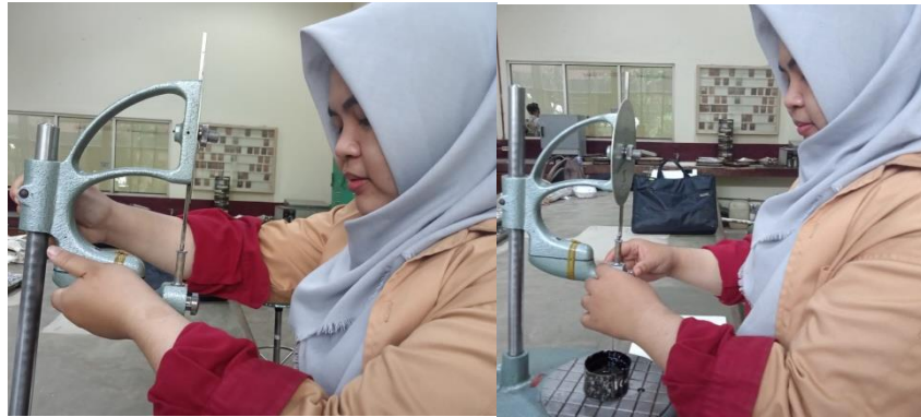
Gambar 16.2 Pengaturan Posisi Jarum Penetrasi
