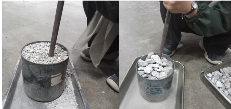
Gambar 5.3 Proses Penumbukan untuk Pemadatan Agregat Kasar di Dalam Bejana
