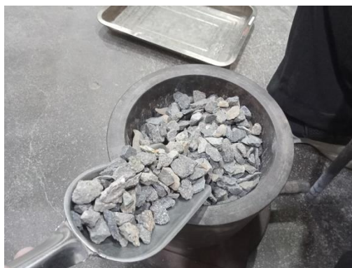
Gambar 6.2 Penuangan Agregat Kasar Tertahan Saringan 12,5 mm dan Tertahan 10 mm Ke Dalam Mould Uji Tekan
