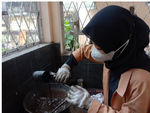
Gambar 18.5 Proses Penuangan Aspal Panas yang Telah Mencapai Suhu 135°C
