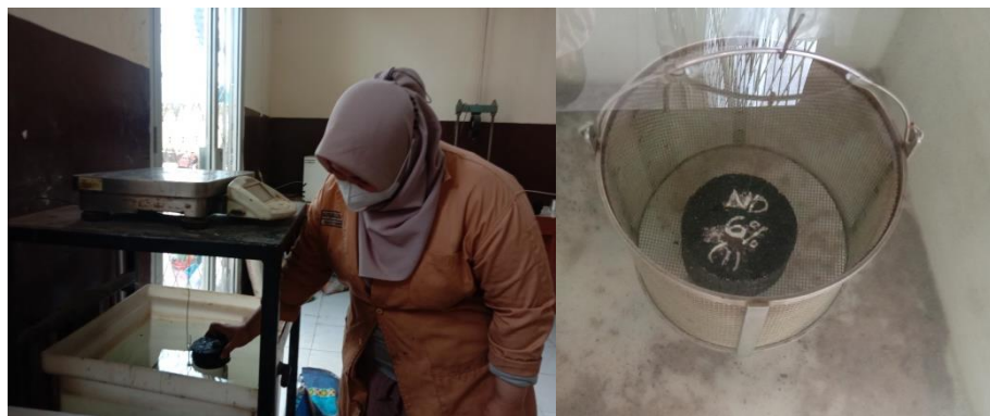
Gambar 19.3 Proses Penimbangan Berat di Dalam Air Benda Uji
