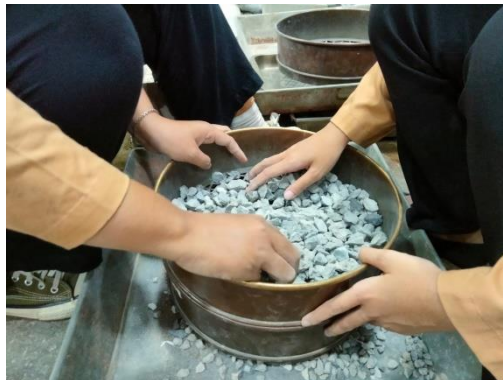
Gambar 6.1 Proses Pemilahan/Penyaringan Agregat Kasar Tertahan Saringan 12,5 mm dan Tertahan Saringan 10 mm
