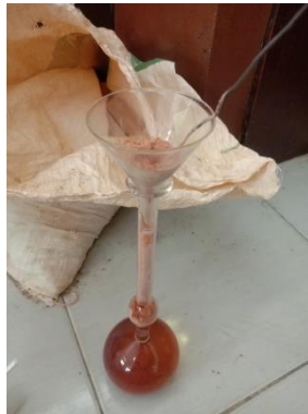
Gambar 12.3 Penuangan Serbuk Bata Merah Secara Bertahap ke Dalam Labu Le Chatelier
