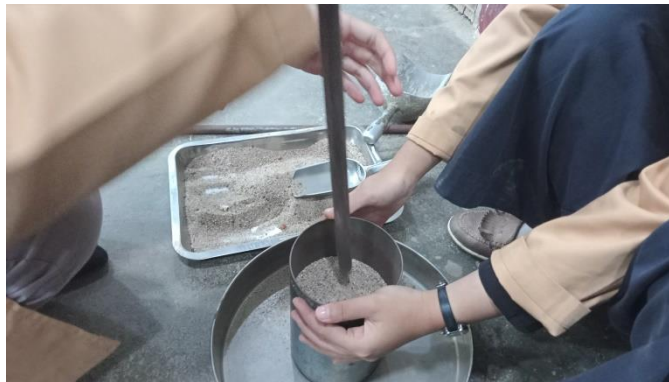
Gambar 11.4 Penumbukan Agregat Halus Sebanyak 25 kali Setiap Lapisan
