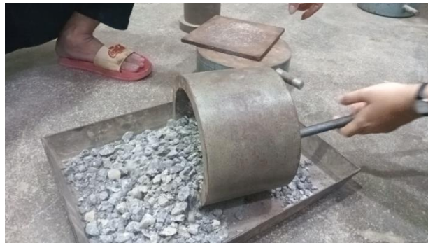
Gambar 6.5 Proses Penuangan Agregat Kasaryang Telah Dilakukan Uji Tekan
