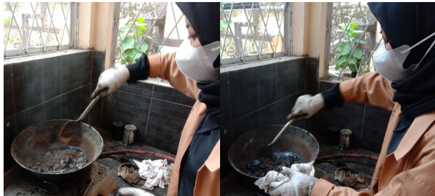
Gambar 18.6 Proses Pencampuran Material Agregat dan Aspal Sampai Suhu 165°C
