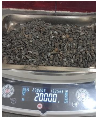
Gambar 4.1 Penimbangan Agregat Kasar Sebanyak 2000 Gram
