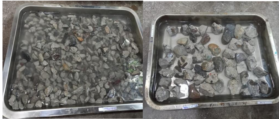
Gambar 3.2 Proses Perendaman Agregat Kasar Selama \pm 24 Jam
