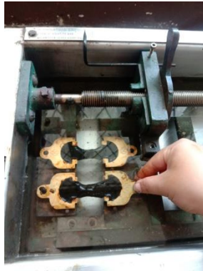
Gambar 17.2 Pemasangan Cetakan Daktilitas Pada Alat Uji Daktilitas
