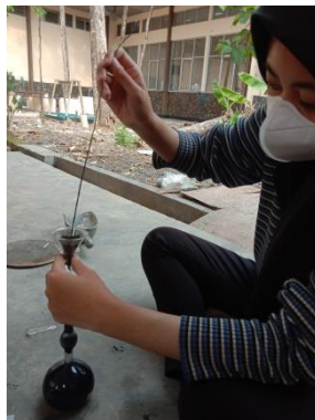
Gambar 13.3 Proses Penuangan Fly Ash ke Dalam Labu Le Chatelier
