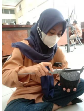
Gambar 19.1 Proses Pengukuran Diameter dan Tinggi Dari Benda Uji Menggunakan Jangka Sorong
