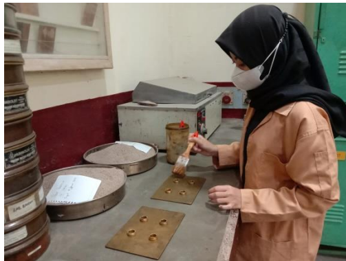
Gambar 15.1 Pengolesan Plat dan Cincin Titik Lembek dengan Oli
