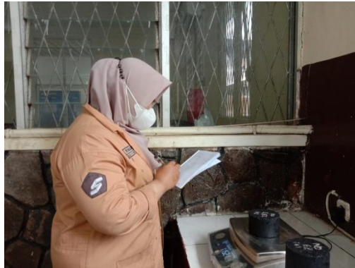
Gambar 19.4 Penimbangan Berar Jenuh Air Benda Uji
