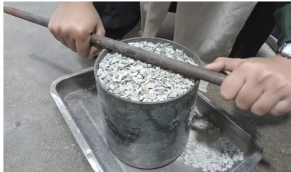
Gambar 5.4 Proses Perataan Agregat Kasar Dalam Bejana
