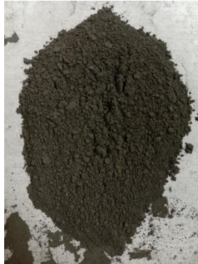
Gambar 13.1 Serbuk Fly Ash Lolos Saringan No.200 Sebanyak 64 Gram
