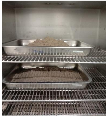
Gambar 10.4 Pengovenan Agregat Halus (Pasir) yang Sudah Dicuci Bersih Sampai Berat Konstan (Tetap)
