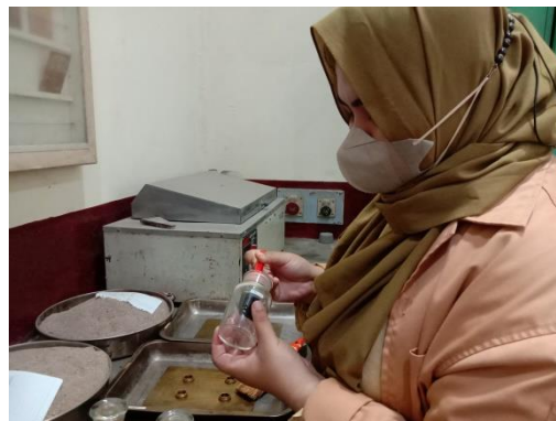
Gambar 14.5 Pengolesan Oli Pada Piknometer untuk Memudahkan Proses Pembersihan Alat
