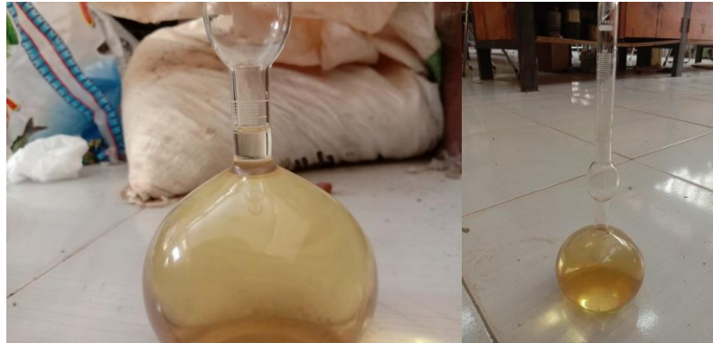
Gambar 12.2 Proses Konstan Minyak Tanah di Dalam Labu Le Chatelier
