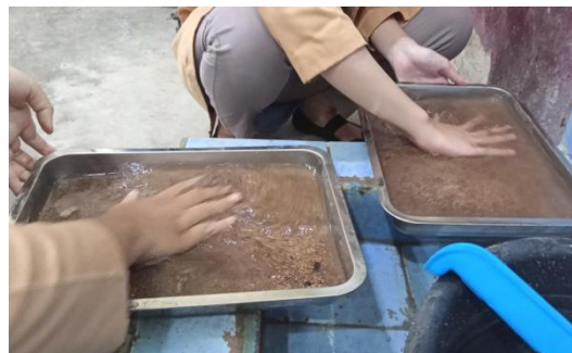
Gambar 10.3 Pencucian Agregat Halus (Pasir) yang Sudah Konstan Sampai Bersih Dari Debu dan Kotoran
