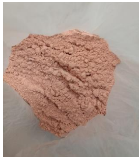
Gambar 12.1 Serbuk Bata Merah Lolos Saringan No. 200 Sebanyak 64 Gram
