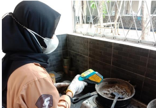
Gambar 18.4 Pengecekan Suhu Sampai 150 °C
