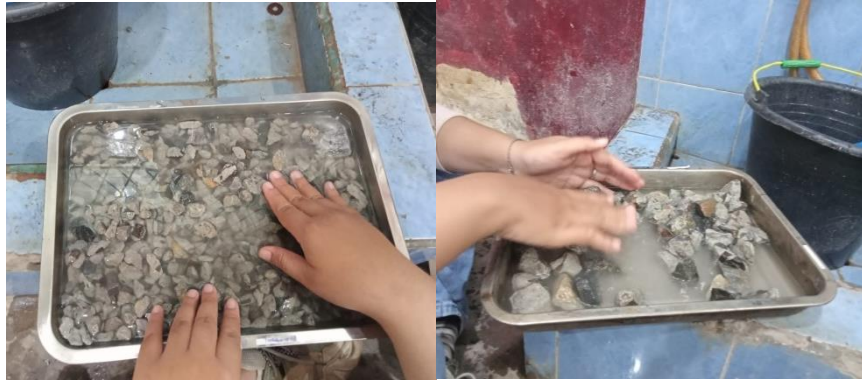
Gambar 4.3 Pencucian Agregat Kasar yang Sudah Konstan Sampai Bersih Dari Debu dan Kotoran
