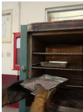
Gambar 10.2 Proses Pengovenan Agregat Halus Sampai Berat Konstan (Tetap)
