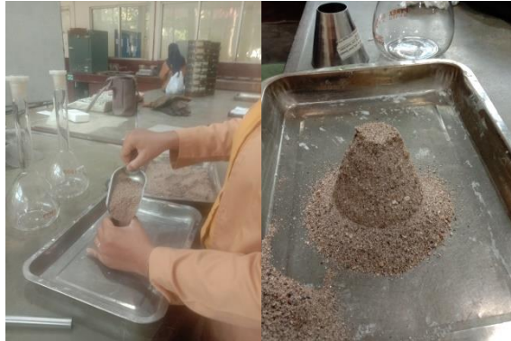
Gambar 9.1 Proses Mencari Material Agregat Halus (Pasir) Dalam Keadaan Kering Permukaan Jenuh/SSD
