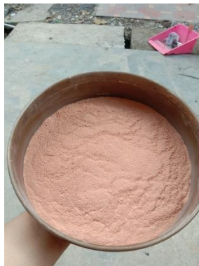
Gambar 1.3 Proses Pengayakan Serbuk Bata Merah Lolos Saringan No.200
