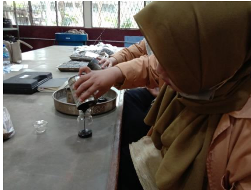
Gambar 14.6 Penuangan Aspal Cair ke Dalam Piknometer
