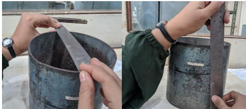
Gambar 5.1 Pengukuran Diameter dan Tinggi Dari Bejana untuk Mendapatkan Volume Bejana
