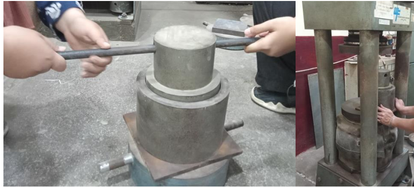
Gambar 6.3 Pengangkatan Mould ke Alat Uji Tekan
