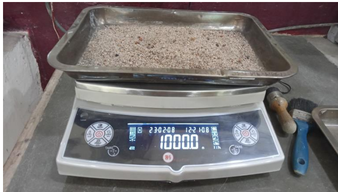
Gambar 8.1 Penimbangan Agregat Halus (Pasir) Sebanyak 1000 Gram
