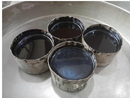
Gambar 16.1 Persiapan Benda Uji untuk Penetrasi
