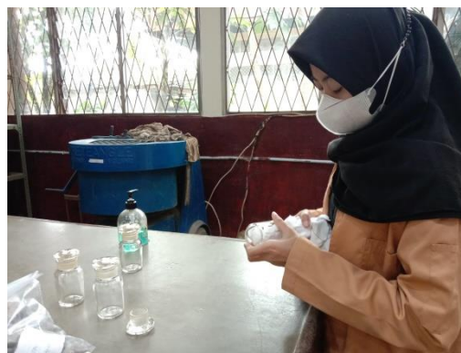
Gambar 14.4 Proses Pengeringan Piknometer Menggunakan Lap
