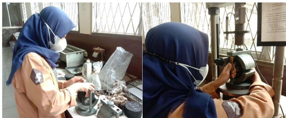
Gambar 19.5 Peletakan Benda Uji Pada Alat Uji Marshall
