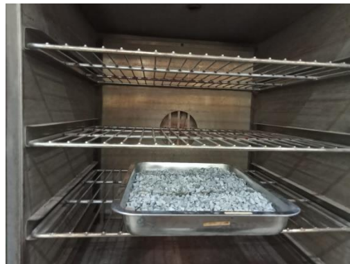
Gambar 4.2 Pengovenan Agregat Kasar Hingga Berat Agregat Kasar Menjadi Konstan
