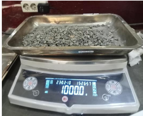
Gambar 2.4 Penimbangan Agregat Kasar Sebanyak 1000 Gram
