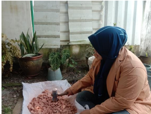
Gambar 1.2 Proses Penghancuran Batu Bata Merah Menjadi Serbuk
