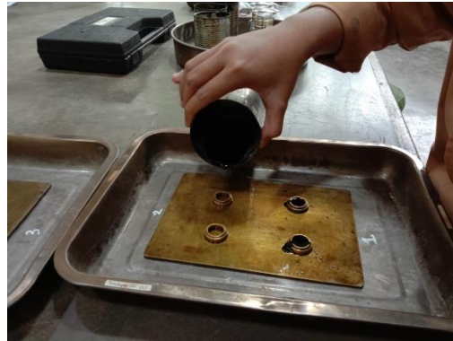
Gambar 15.2 Penuangan Aspal Cair ke Dalam Cincin Titik Lembek
