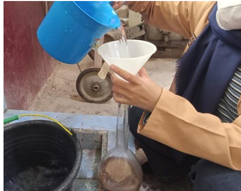
Gambar 9.4 Penuangan Air ke Dalam Piknometer + Agregat Halus (Pasir)
