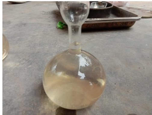
Gambar 13.2 Proses Konstan Minyak Tanah di Dalam Labu Le Chatelier
