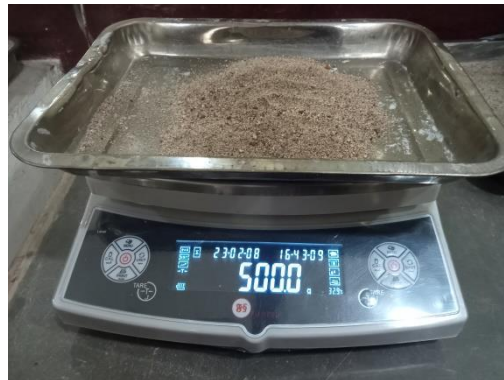
Gambar 9.2 Penimbangan Agregat Halus (Pasir) Keadaan Kering Permukaan Jenuh/SSD Sebanyak 500 Gram
