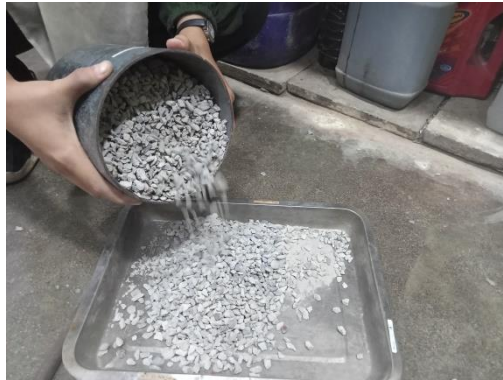
Gambar 5.6 Penuangan Agregat Kasar yang Telah Digunakan untuk Tahapan Pertama Bobot Isi Agregat Kasar
