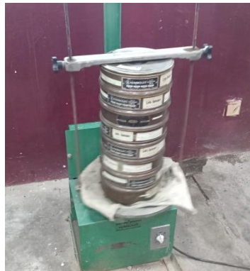
Gambar 2.5 Proses Pengayakan Agregat Kasar Menggunakan Alat Penggetar Saringan Selama 15 Menit
