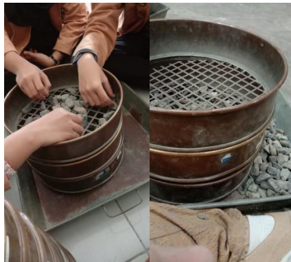
Gambar 7.1 Proses Pemilahan Agregat Kasar untuk Gradasi A
