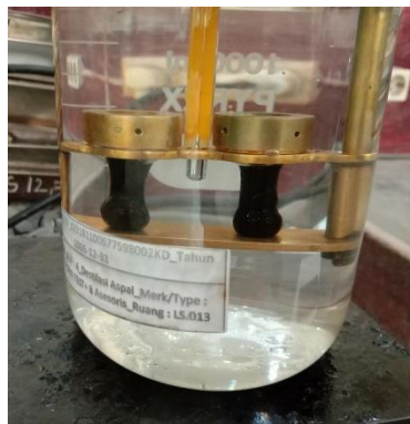
Gambar 15.5 Proses Uji Titik Lembek dengan Mencatat Waktu Setiap Kenaikan Suhu 5°C Sampai Aspal Menyentuh Plat
