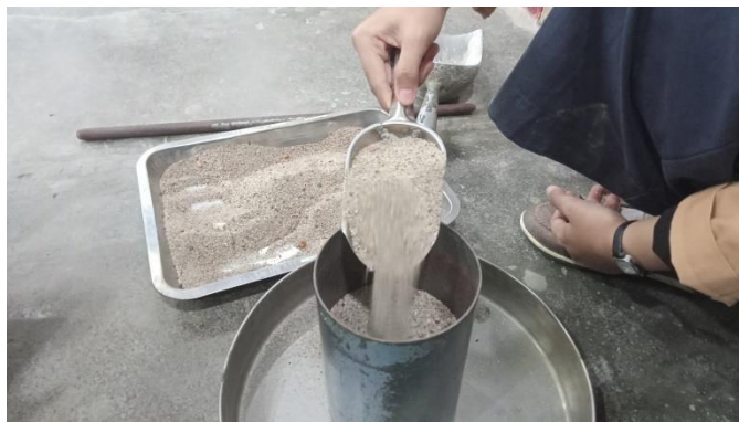
Gambar 11.2 Penuangan Agregat Halus (Pasir) ke Dalam Bejana Silinder
