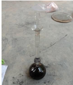
Gambar 13.4 Proses Konstan Fly Ash di Dalam Labu Le Chatelier
