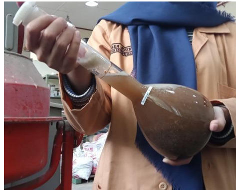
Gambar 9.5 Proses Pengguncangan Pycnometer Secara Perlahan untuk Menghilangkan Gelombang Air di Dalam Pycnometer
