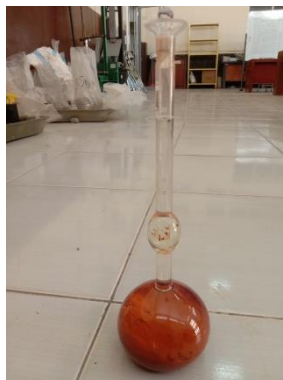
Gambar 12.4 Proses Konstan Serbuk Bata Merah di Dalam Labu Le Chatelier
