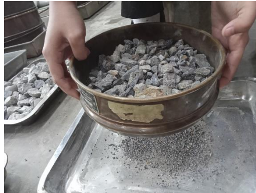
Gambar 6.6 Proses Pengayakan Agregat Kasar Hasil Uji Tekan Dengan Lolos Saringan Nomor 2,36 mm
