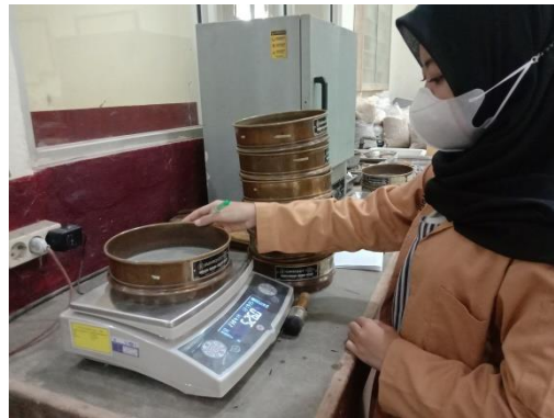
Gambar 2.1 Penimbangan Masing – Masing Ukuran Saringan
