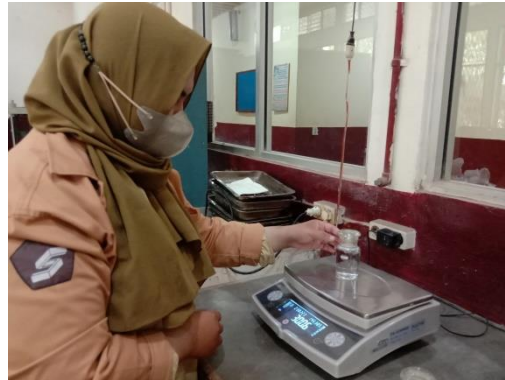
Gambar 14.3 Penimbangan Piknometer + Air
