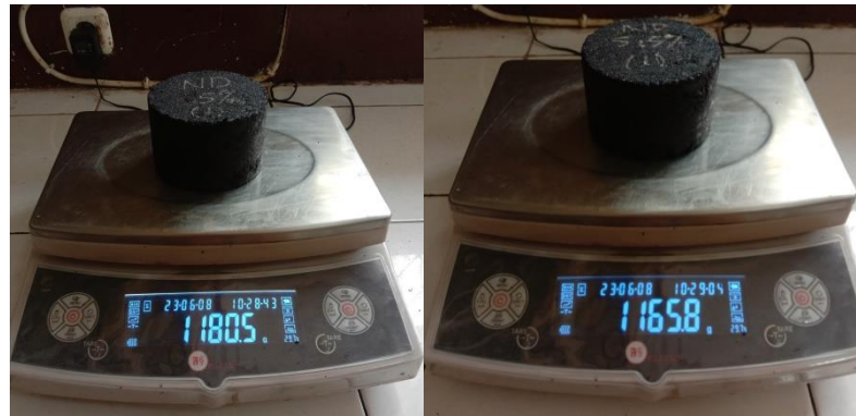
Gambar 19.2 Penimbangan Berat Kering Benda Uji
