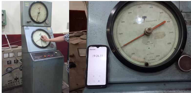
Gambar 6.4 Proses Uji Tekan Agregat Kasar
