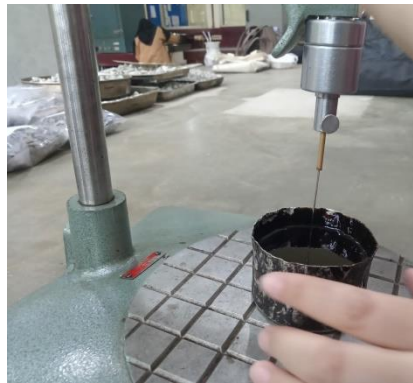
Gambar 16.3 Proses Pengujian Penetrasi
