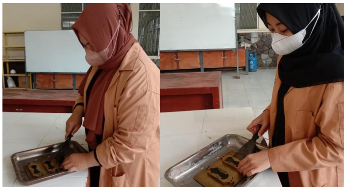
Gambar 17.1 Proses Pelepasan Cetakan Daktilitas Dari Plat Kuningan
