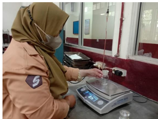
Gambar 14.2 Penimbangan Piknometer Kosong
