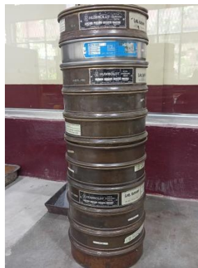
Gambar 2.2 Penyusunan Saringan Berdasarkan Ukuran
