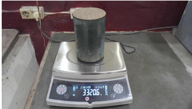
Gambar 11.3 Penimbangan Bejana Silinder + Agregat Halus (Pasir)
