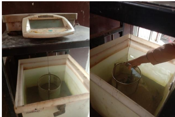
Gambar 3.1 Proses Penimbangan Agregat Kasar Di Dalam Air
