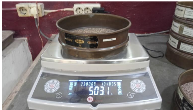
Gambar 8.3 Penimbangan Masing – Masing Saringan yang Sudah Digetarkan di Mesin Penggetar Selama 15 Menit
