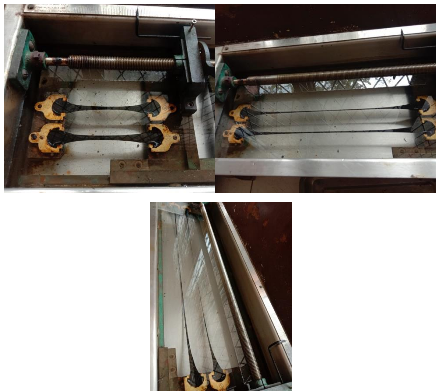
Gambar 17.3 Proses Pengujian Daktilitas
