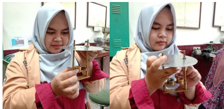
Gambar 15.4 Proses Pemasangan Bola – Bola Baja dan Penutup Cincin Pada Dudukan Benda Uji
