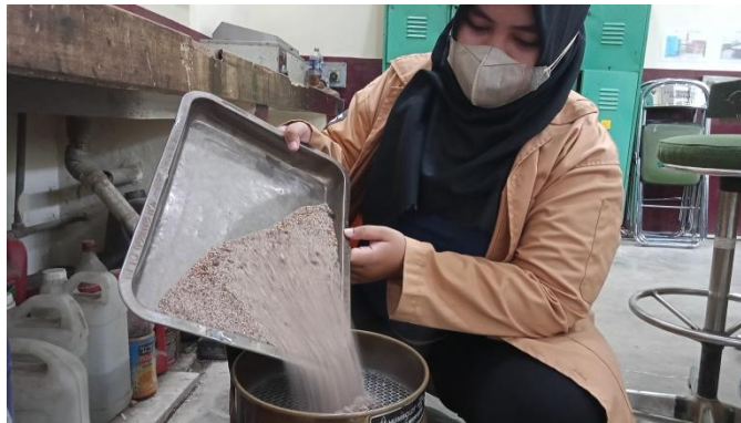
Gambar 8.2 Penuangan Agregat Halus (Pasir) ke Dalam Saringan yang Sudah Disusun
