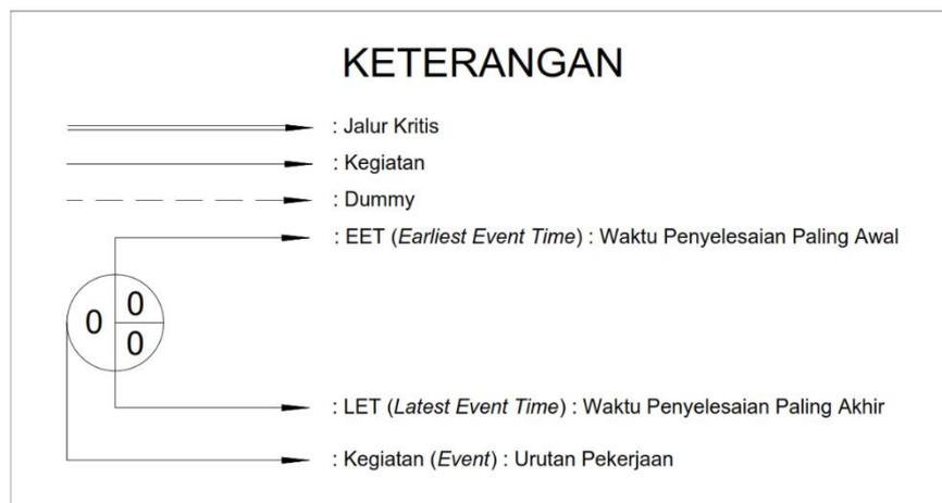
**Gambar 2.30** Keterangan *Critical Path Method* pada *Network Planning*
