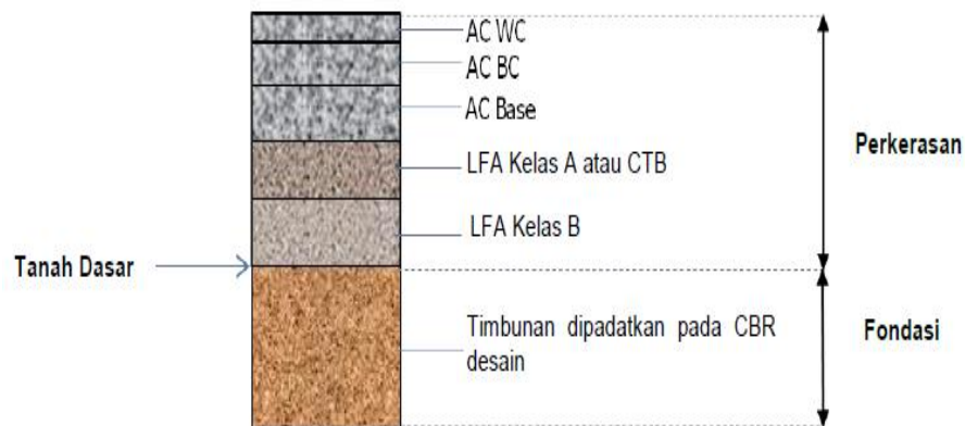
Gambar 2.27 Perkerasan Lentur pada timbunan
