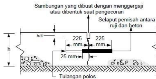
Gambar 2.22 Sambungan Susut Melintang dengan Ruji
