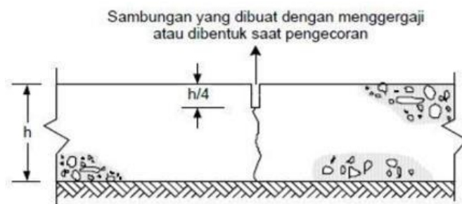
Gambar 2.29 Sambungan Susut Melintang tanpa Ruji
