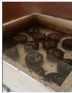
perendaman benda uji dalam waterbath
