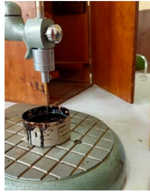
memasukkan aspal cair pada piknometer menurunkan jarum di atas permukaan sampel
