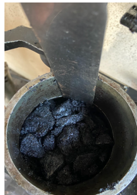
masukkan campuran aspal kedalam molt dan ratakan
