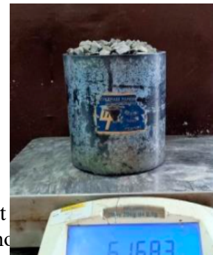
penimbangan bobot isi padat agregat kasar
