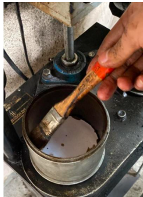
oleskan oli pada molt yang sudah dipasang di alat penumbuk
