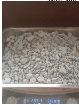
Penimbangan bobot isi padat agregat halus
