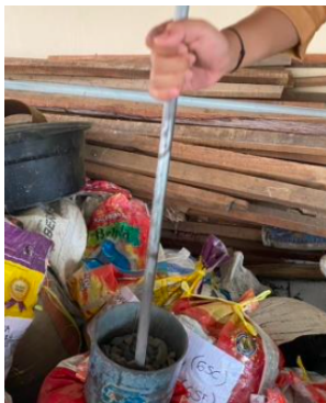
penimbangan bobot isi gembur agregat kasar
