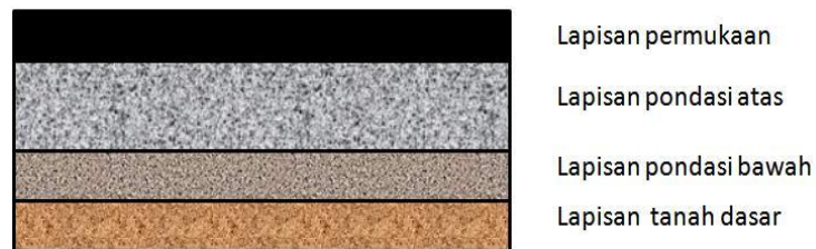
Gambar 2. 2 Konstruksi Perkerasan Lentur
