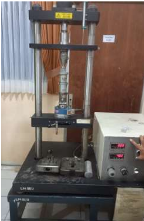
Proses Pengujian Kekerasan pada Bahan Peleburan
