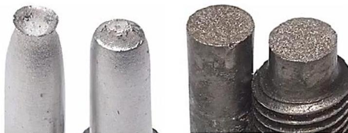
Gambar 2.15 Patah Akibat Tegangan Maksimum
