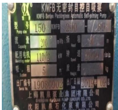
Gambar 2. 2 Speksifikasi pompa intake PLTU TE 3x10 MW (PT. BEST, 2021)
