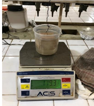
Menimbang Berat Spesimen di dalam Air
