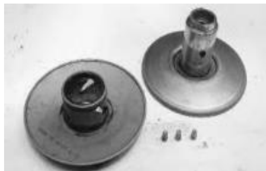
Gambar 2. 29 Bagian - bagian secondary fixed sheave (Marsudi, 2017)
