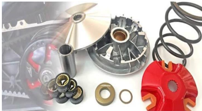
Gambar 2. 12 Bagian – bagian pulley primer (Marsudi, 2017)
