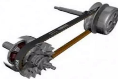
Gambar 2. 49 Gambar kerja pulley sekunder saat putaran menengah (Marsudi, 2017)
