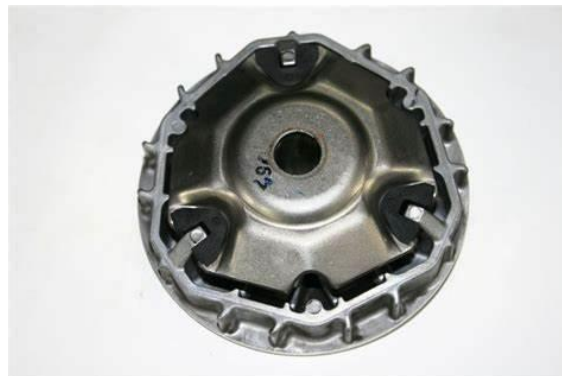
Gambar 2. 21 Pengarah pergerakan slider (Marsudi, 2017)
