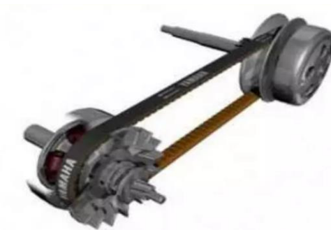
Gambar 2. 52 Gambar kerja pulley sekunder saat putaran tinggi (Marsudi, 2017)
