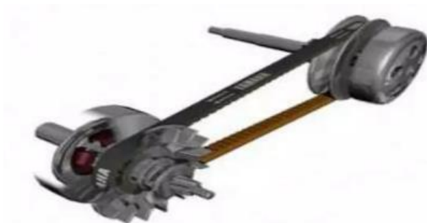
Gambar 2. 44 Sistem CVT pada putaran idle (Marsudi, 2017)
