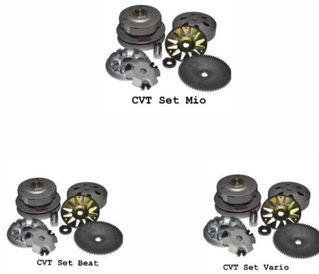
Gambar 2. 7 Komponen – komponen sistem CVT pada motor (Marsudi, 2017)
