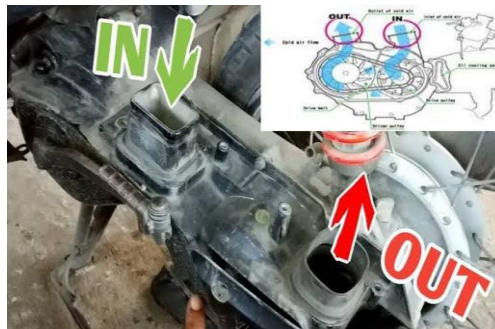
Gambar 2. 4 Sirkulasi udara pendingin (Marsudi, 2017)
