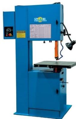
**Gambar 2.3** Mesin Gergaji Pita (PT. LFC, 2021)
