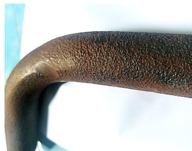
Gambar 2.5 contoh kerusakan akibat proses solid particle impingement
